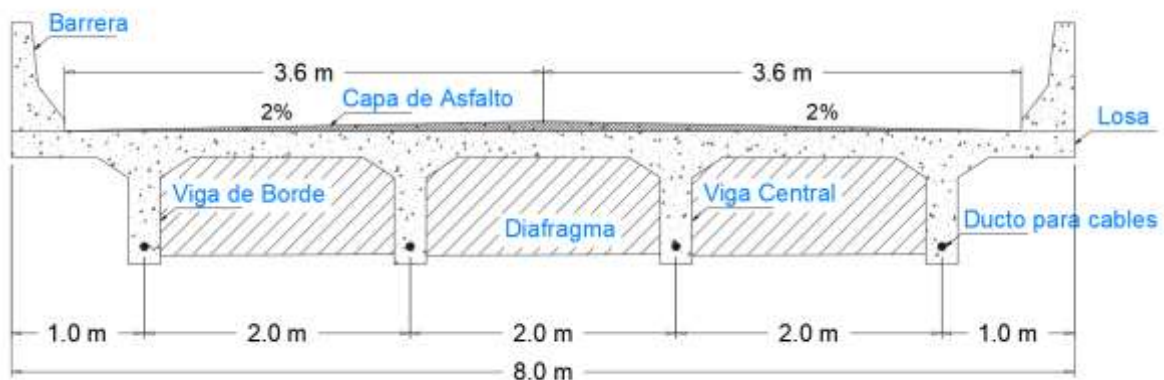
Figura 2.1. Vista frontal del puente con vigas de hormigón postensadas
