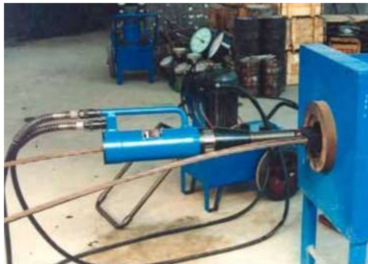
Figura 1.8. Gato para postensado de monotorón. Fuente: CPS, 2019 [15].
