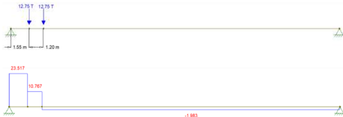
Figura 2.26. Diagrama de corte debido al tándem de diseño (T).
