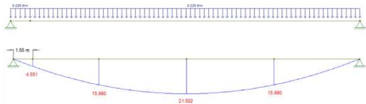
Figura 2.29. Diagrama de momento por carga debido a la superficie de rodadura (T).
