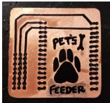
Figura 3.39. Circuito plasmado en placa virgen
