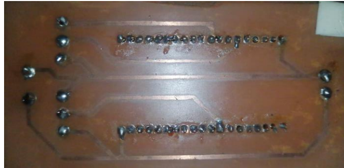
Figura 3.16 Soldadura de la placa PCB con los componentes electrónicos montados
