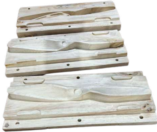
Figura 5. Moldes fabricados en CNC.
