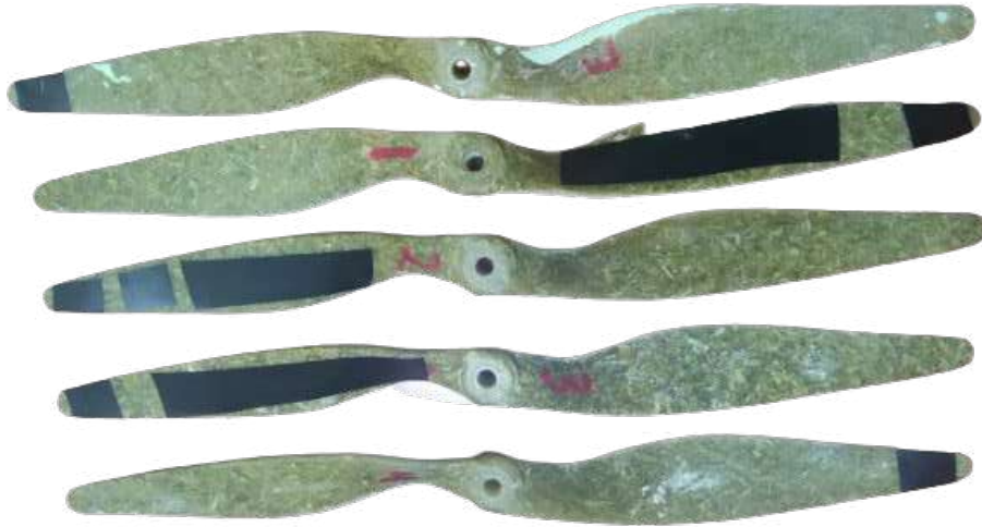
Figura 13. Propelas balanceadas (Fuente: propia)
