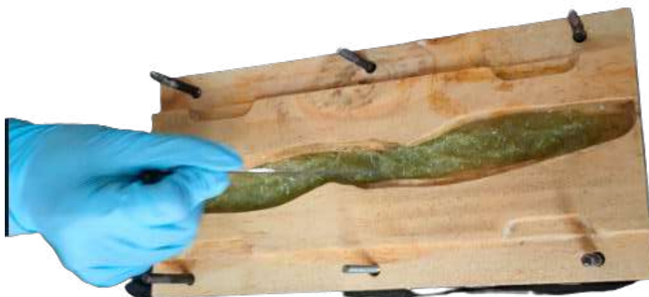
Figura 11. Compactado del material en el molde. (Fuente: propia)
