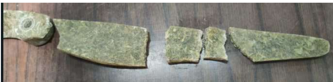
Figura 16. Propela fracturada al 50% de aceleración. (Fuente: propia)
