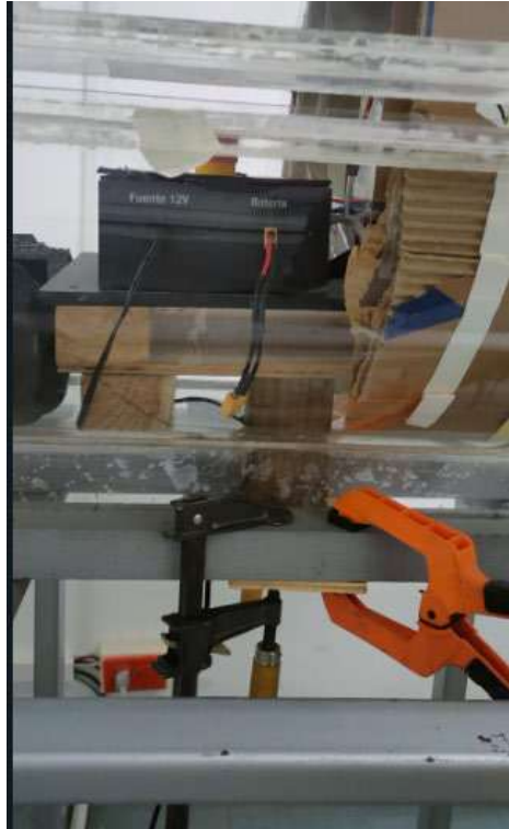
Figura 15. Soporte de madera colocado en el banco de pruebas y asegurado con prensas (Fuente: propia)
