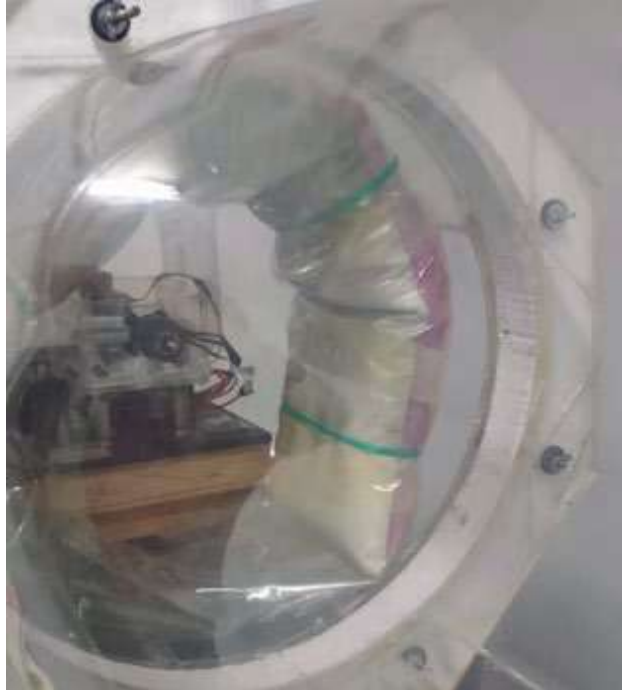
Figura 17. Recubrimiento del túnel de viento en área crítica. (Fuente: propia)
