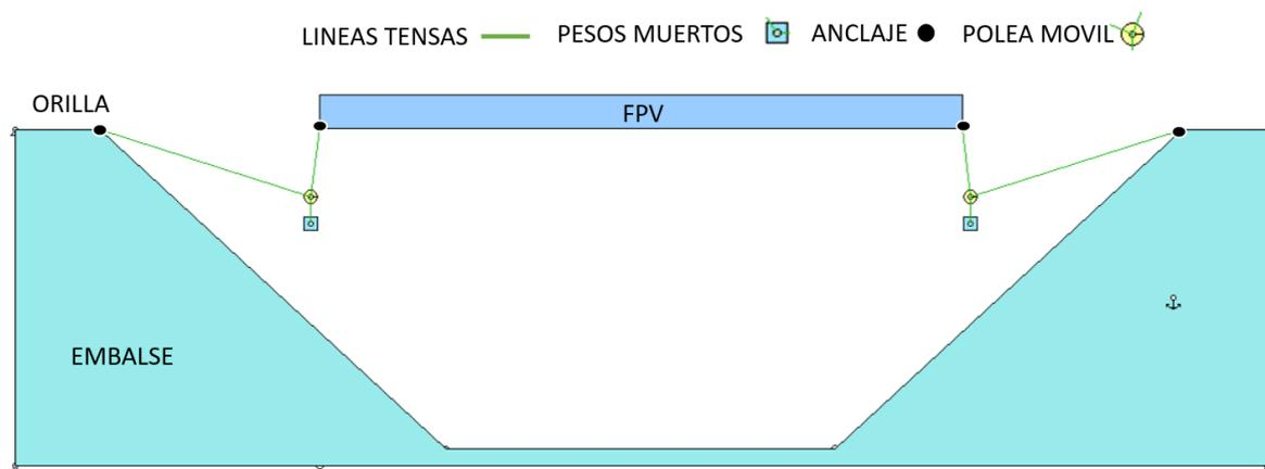
**Figura 2. 14** Sistema de amarre tensado con pesos muertos y poleas cota superior
