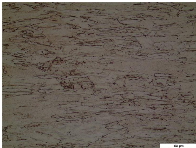
Figura 2.12 Micrografía de alambre de 1.5 en diámetro lubricado con aceite luego del ataque químico
