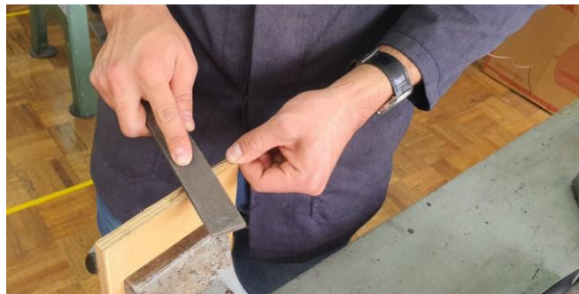
Figura 2.2 Ahusado del alambre de cobre
