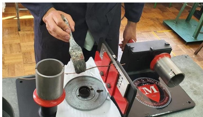
Figura 2.3 Lubricación del alambre de cobre
