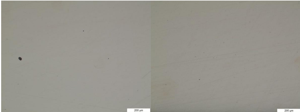
Figura 2.11 Micrografías de alambre de 1.5 y 2.1 en diámetro trefilados con grasa.
