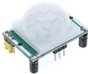
**Figura 2.13.** Sensor de movimiento PIR infrarojo HC-SR501 [75]
