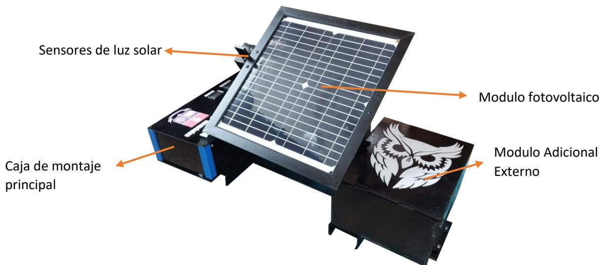
**Figura 3.1.** Prototipo de sistema energético
