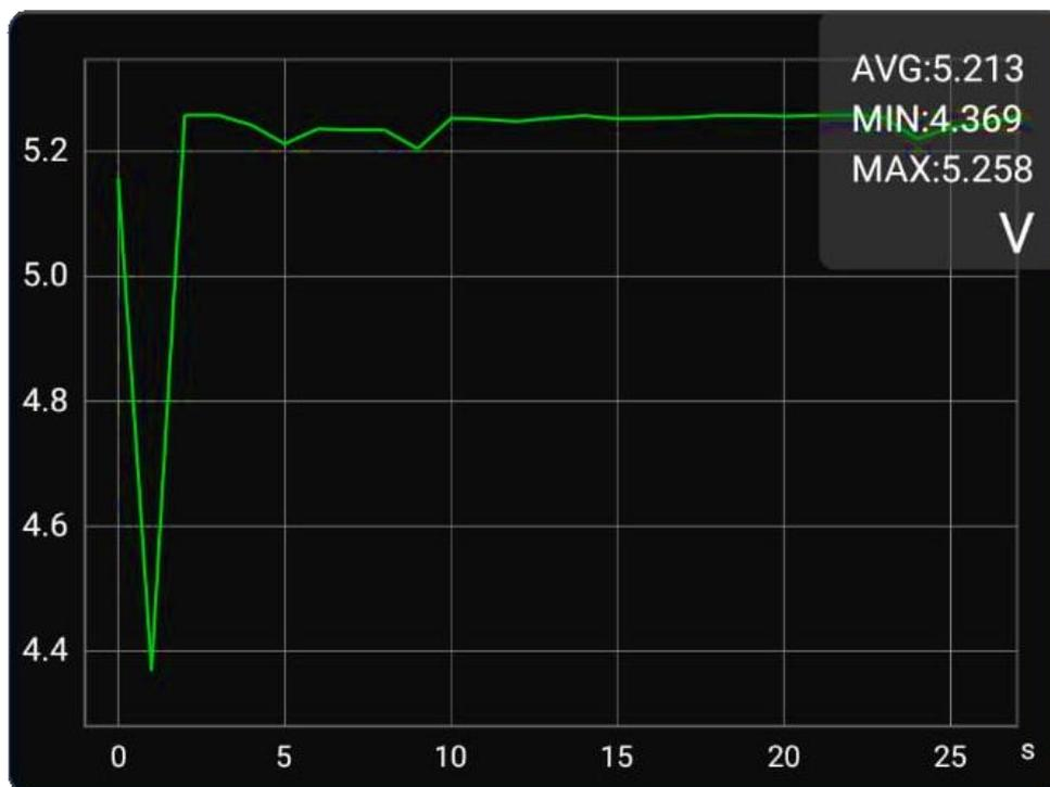
Figura 3.9. Voltaje medido en los USB para periféricos
