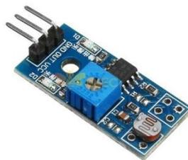
**Figura 2.12.** Modulo sensor de luz con potenciómetro [74]
