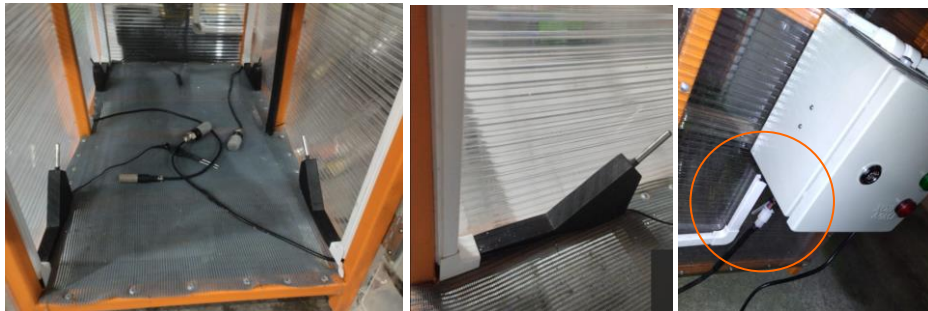
Figura 2. 11. Disposición de los sensores de temperatura DSB18B20.
