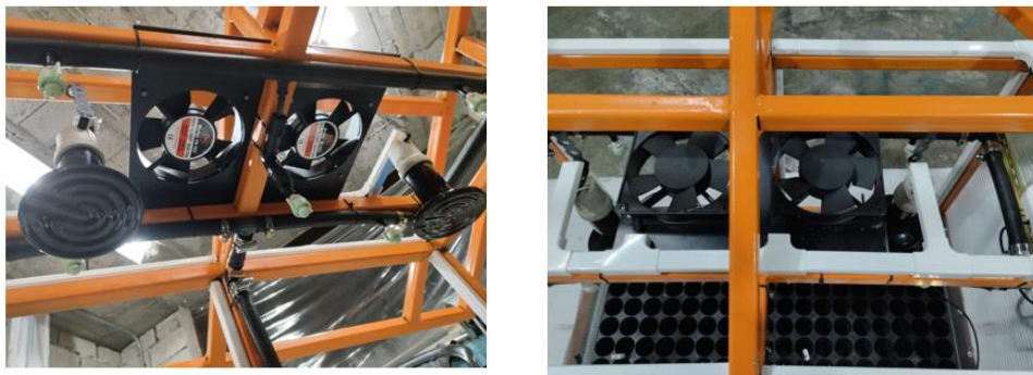
Figura 2. 9. Disposición de actuadores para la calefacción del prototipo.
