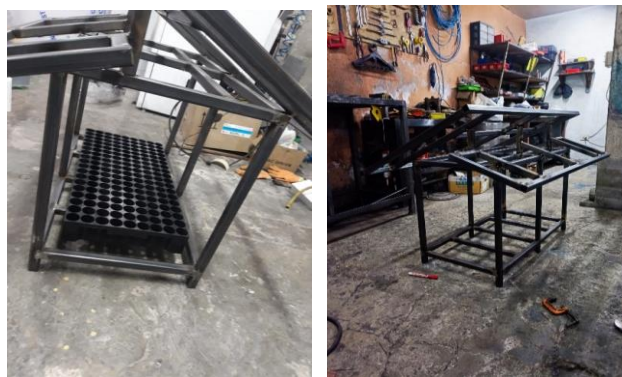
Figura 2. 2. Estructura del prototipo en acero A36.
