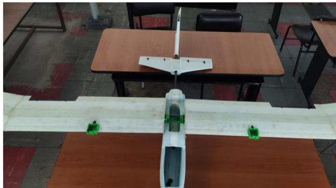
Figura 2.33. Unión fuselaje y alas / Fuente: propia
