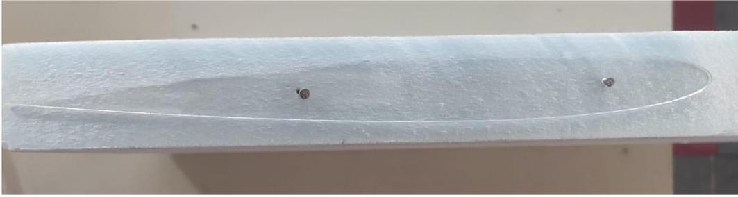
Figura 2.7. Perfil de acrílico centrado en el bloque cortado de XPS / Fuente: propia
