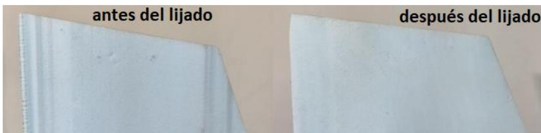
Figura 2.12 Lijado de componentes en XPS / Fuente: propia
