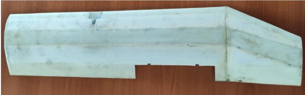
Figura 2.15. Recubrimiento localizado ala / Fuente: propia
