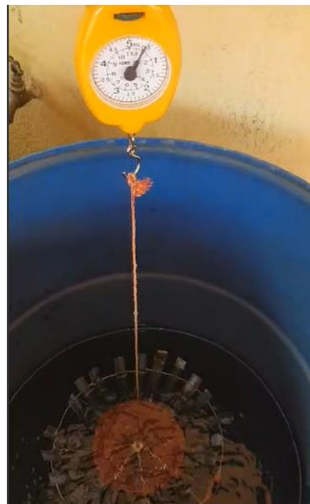
Figura 26. Obtención de peso sumergido ( W_s ) Fuente: propia.
