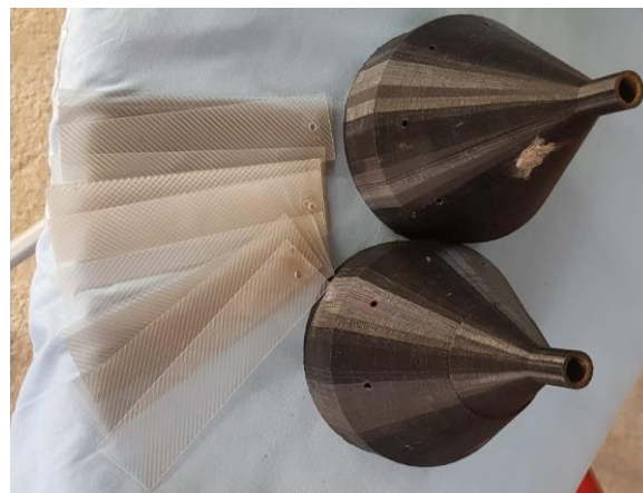
Figura 33. Embudos con impresión 3D y aletas de polipropileno Fuente: propia
