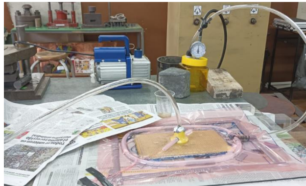
Figura 46. Conexiones completas en el sistema de infusión al vacío.
