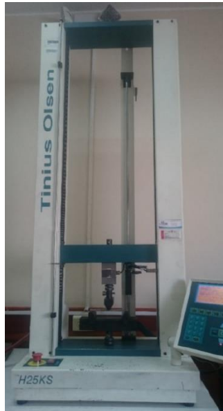
Figura 30. Tinius Olsen H25KS máquina universal de ensayos [1].
