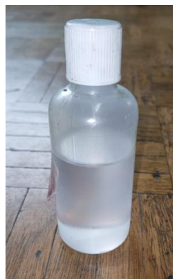
Figura 9. PEROXICOL 80 (Peróxido de Metil Etil Cetona), catalizador
