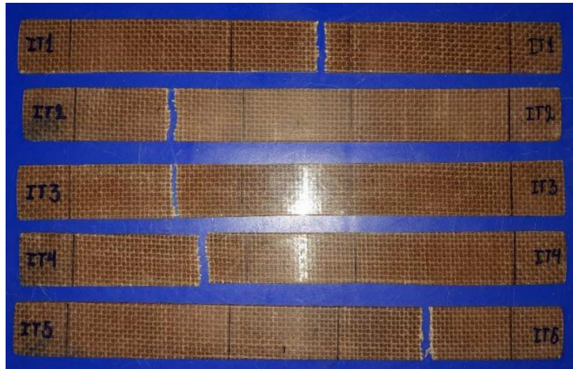
Figura 55. Probetas de tracción mediante infusión al vacío posterior al ensayo de tracción.
