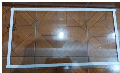
Figura 40. Ubicación de la cinta de butilo en un recuadro cerrado sobre la base de vidrio.
