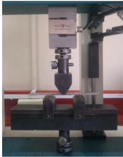
Figura 32. Ensayo de flexión aplicando método de los 3 puntos [1].
