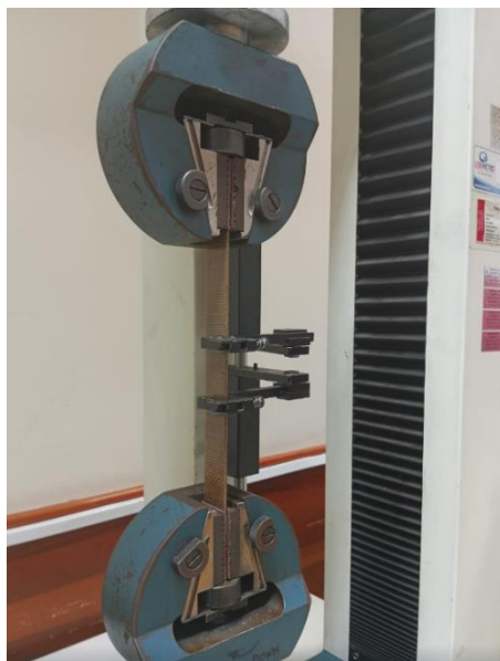
Figura 31. Adaptación de mordazas cuneiformes y extensómetro.
