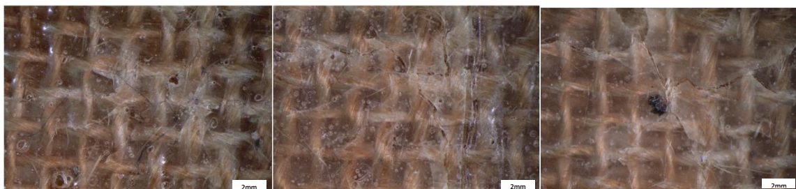
Figura 68. Macrografías con aumento 8x en probetas de impacto
