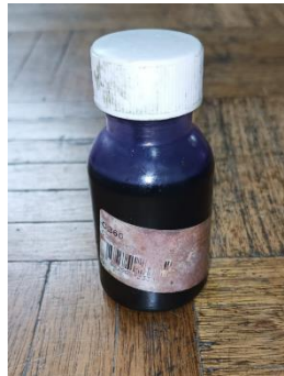
Figura 10. Octoato de cobalto 12%, acelerador.
