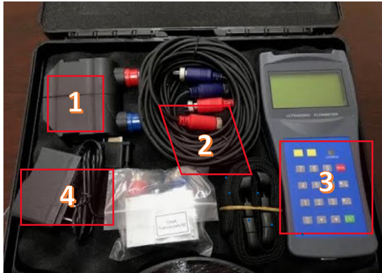
Figura 12. Medidor ultrasónico de caudal presente en los laboratorios de Hidráulica EPN, (1) Transductores medianos, (2) cables de señal 16.4 pies para conectar transductores, (3) medidor de flujo ultrasónico portátil, (4) Cargador de batería.
