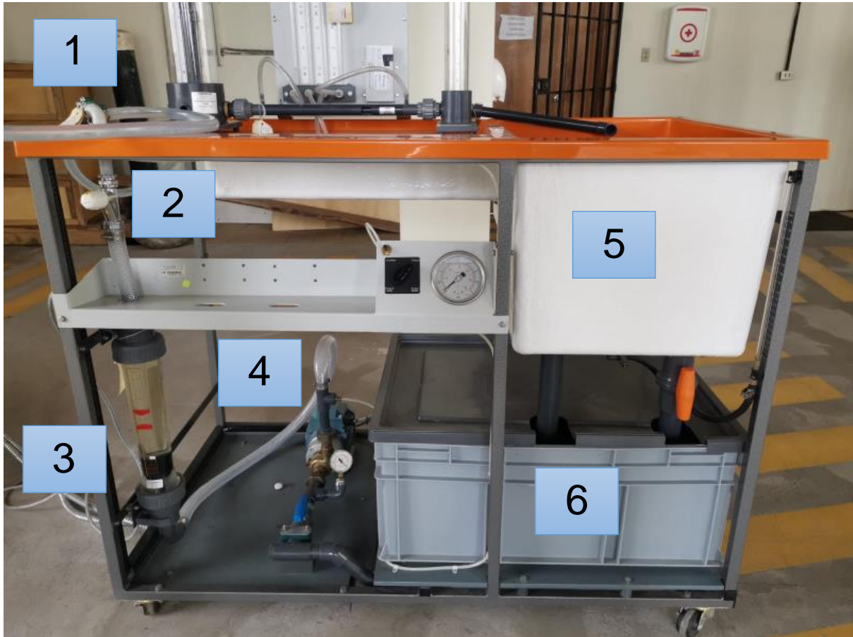
Figura 11. Banco hidráulico presente en el laboratorio docente de hidráulica Escuela Politécnica Nacional (1) salida para conexión al accesorio adaptable \frac{3}{4} ", (2) válvula regulación de caudal, (3) rotámetro. (4) Bomba marca Stuart Turner, (5) tanque de evacuación del fluido, (6) tanque reservorio
