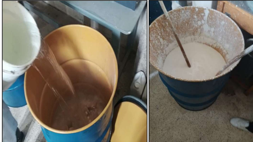
Figura 8. Proceso de hidratación de la piedra caliza
