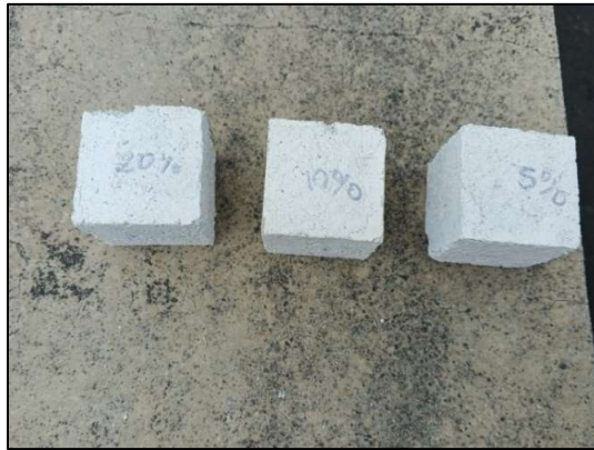
Figura 46. Morteros de cal apagada con sustitución parcial de mucílago de nopal en porcentajes del 5%, 10% y 20% en reemplazo del cementante a 90 días de curado, expuestos al intemperismo (Día 1).
