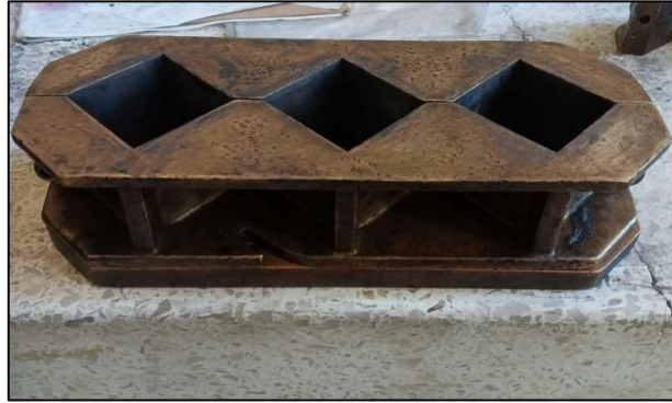
Figura 24. Molde de tres compartimentos para especímenes cúbicos de 50 mm de arista.
