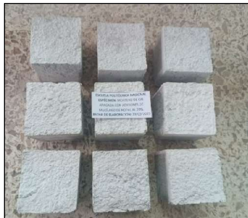
Figura 28. Morteros de cal apagada con sustitución parcial del 10% de nopal con el cementante.
