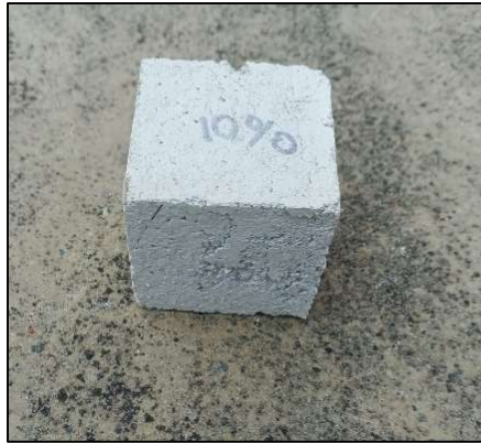
Figura 49. Mortero de cal apagada con adición del 10% de mucílago de nopal en sustitución con el cementante a 90 días de curado (medida de fisuramiento).
