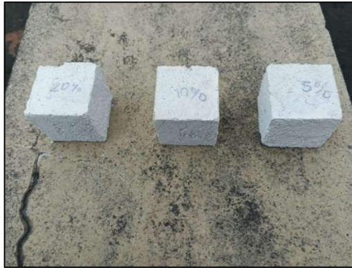
Figura 47. morteros de cal apagada con sustitución parcial de mucílago de nopal en porcentajes del 5%, 10% y 20% en reemplazo del cementante a 90 días de curado, expuestos al intemperismo (Día 60).
