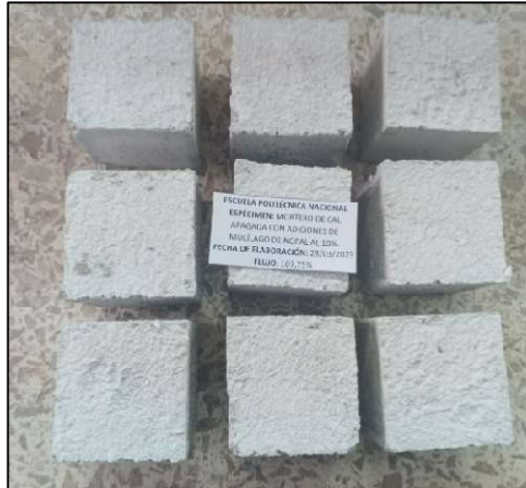
Figura 29. Morteros de cal apagada con sustitución parcial del 20% de nopal con el cementante.
