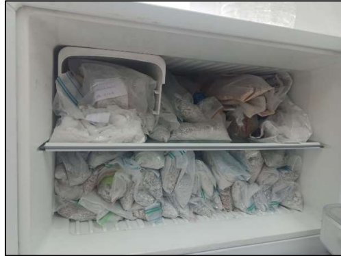
Figura 32. Interrupción de la hidratación de muestras de morteros de cal en refrigeración a 18 °C.
