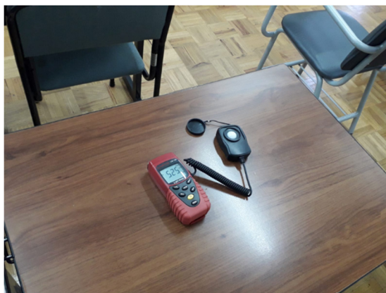
Figura 2.5. Nivel de iluminación medido en el aula 305
