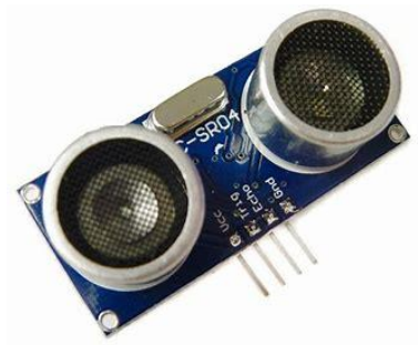
Figura 2.14 Imagen referencial del sensor ultrasónico HC-SR04.
