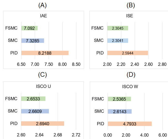
Figura 3.5. Índices de rendimiento para el seguimiento de la trayectoria cerrada tipo círculo de 3m de radio y con velocidad lineal de 0.3 \frac{m}{s} .
