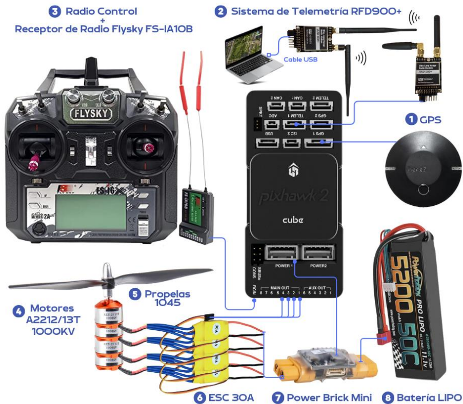
Figura 2.3. Diagrama de interconexión de elementos con Pixhawk Cube [Fuente propia]
