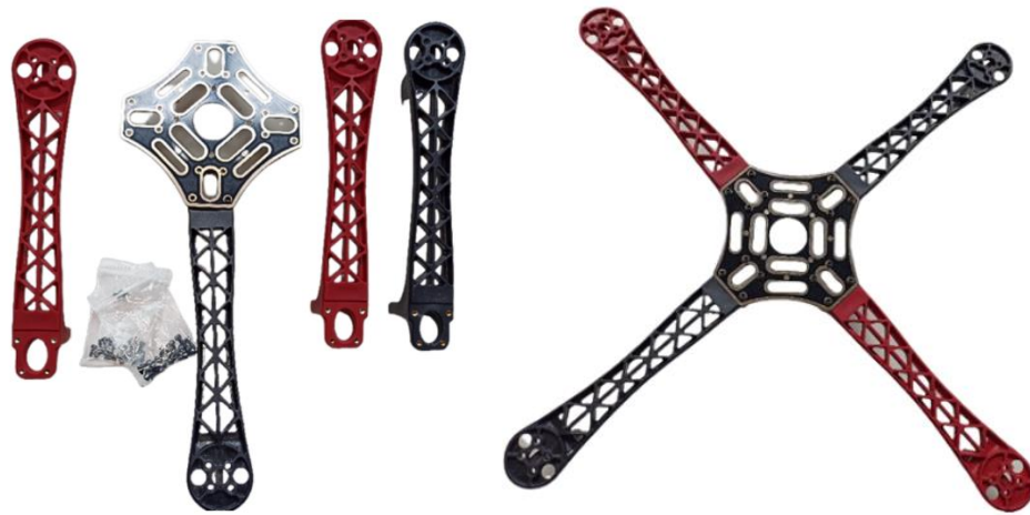
Figura 2.1. Frame F450 del cuadricóptero [Fuente propia]
