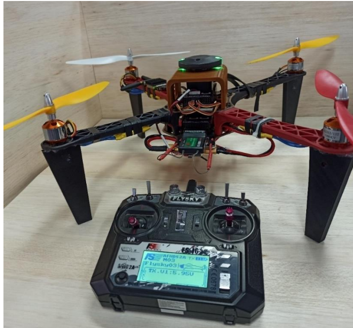
Figura 2.8. Cuadricóptero réplica totalmente integrado [Fuente propia]
