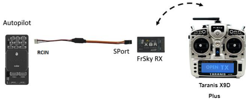
Figura 2.22. Conexión entre controladora de vuelo y radiocontrol [Fuente propia]
