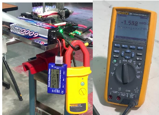
Figura 3.3. Medición de voltaje y corriente con aceleración del 15% [Fuente propia]
