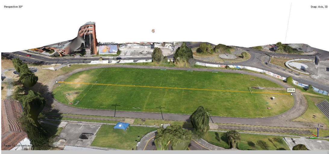
Figura 3.4 Medición longitudinal del estadio de la Escuela Politécnica Nacional [Fuente propia]
