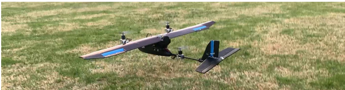
Figura 3.7 Dron tiltrotor nivelado en etapa de despegue con más de 60% de aceleración [Fuente propia]
