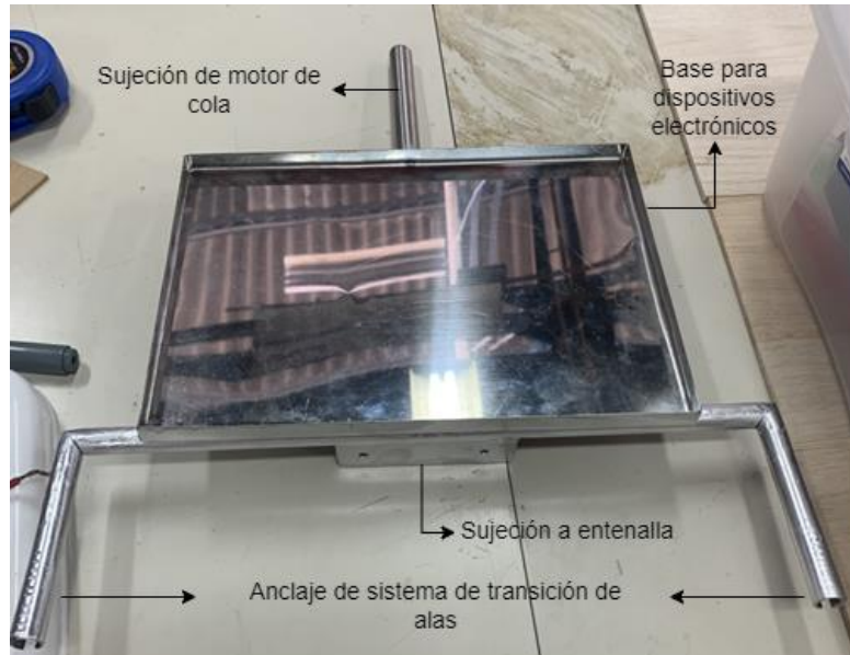
Figura 2.8. Estación de pruebas en tierra [Fuente propia]
