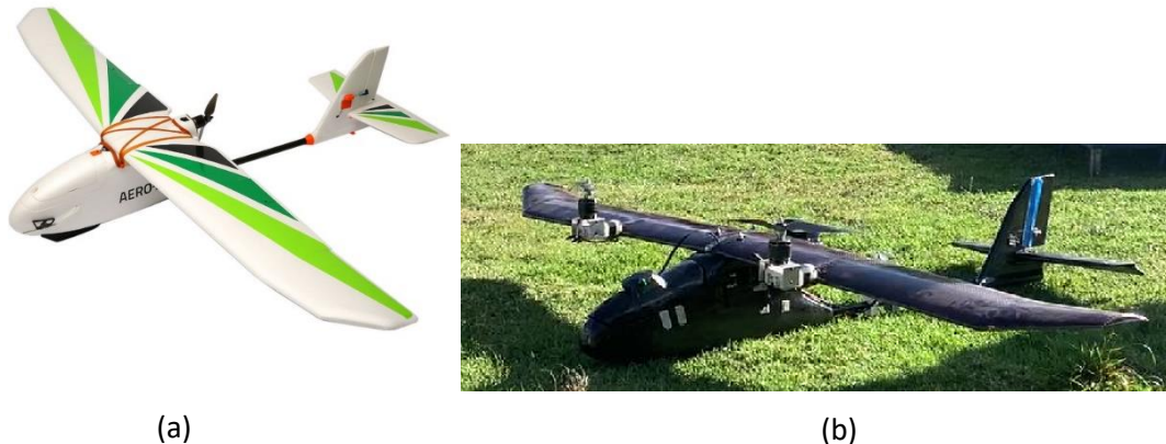
Figura 1.5. UAV 3DR Aero (a) Comercial [10] (b) Modificado con funcionalidad tiltrotor [Fuente propia]
