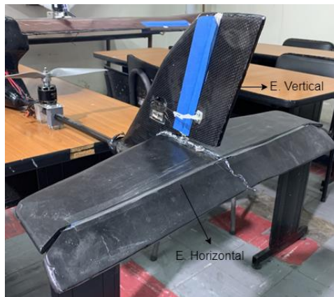
Figura 2.11. Estabilizador vertical y horizontal [Fuente propia]
