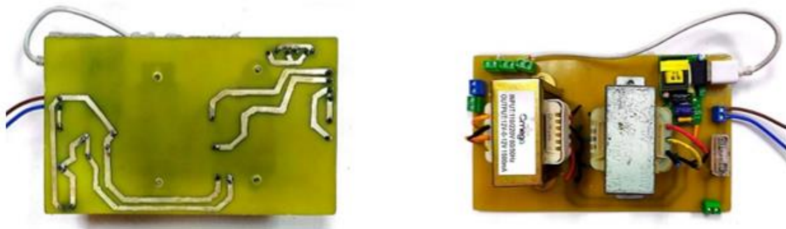
Figura 2.9 Vista posterior y frontal del PCB para el circuito de alimentación
