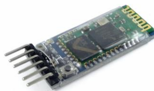
Figura 1.17 Módulo bluetooth HC05 [26]
