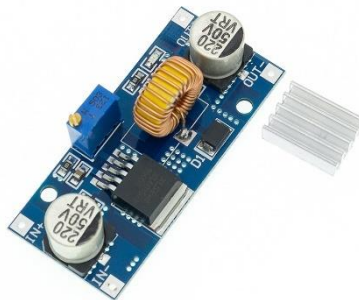
Figura 1.12 Convertidor DC/DC XL4015[14]
