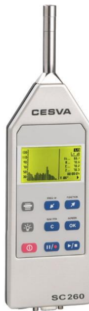
Figura 3.6 Sonómetro CESVA SC260
