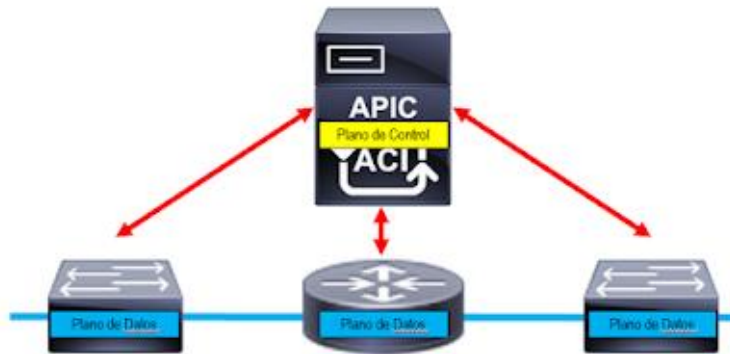
Figura 3. Modelo de una red SDN. [5]
