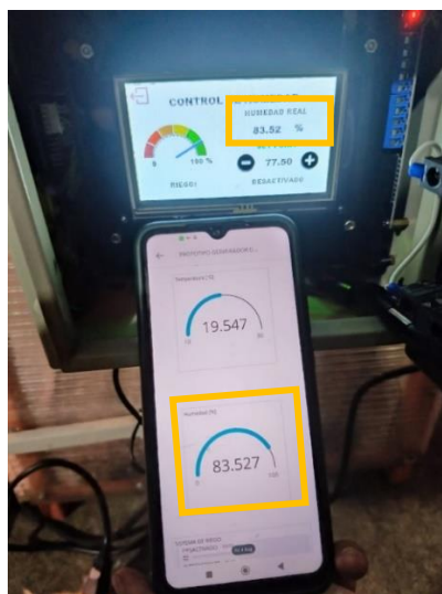
Figura 3.9. Humedad actual en la pantalla “Humedad” y en la aplicación “IoT Remote”
