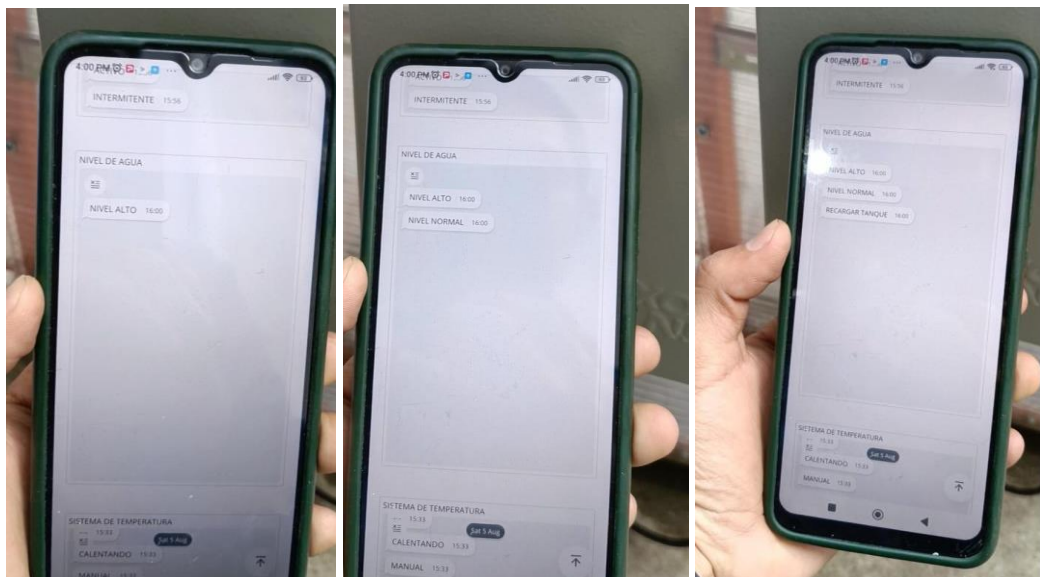
Figura 3.22. Alertas visuales en el tablero de control: (a) Nivel máximo; (b) Nivel normal; (c) Nivel bajo
