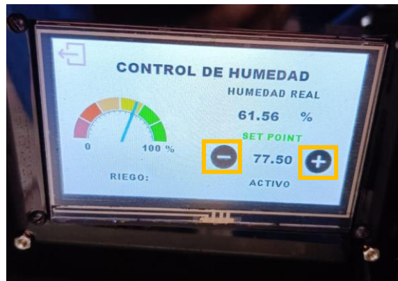
Figura 3.8. Configuración del valor de consigna de Humedad
