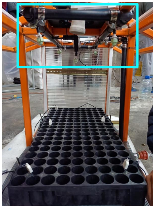
Figura 2.7. Sistema de riego integrado a la estructura
