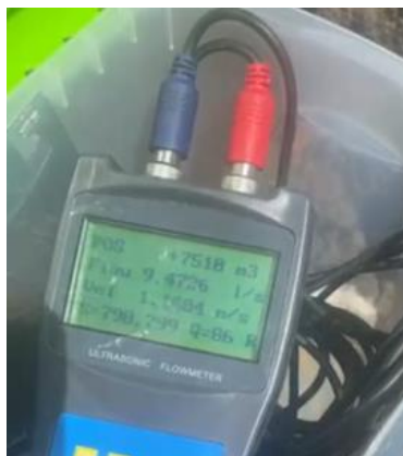
Figura 3: Caudal y velocidad medidos por el medidor ultrasónico
