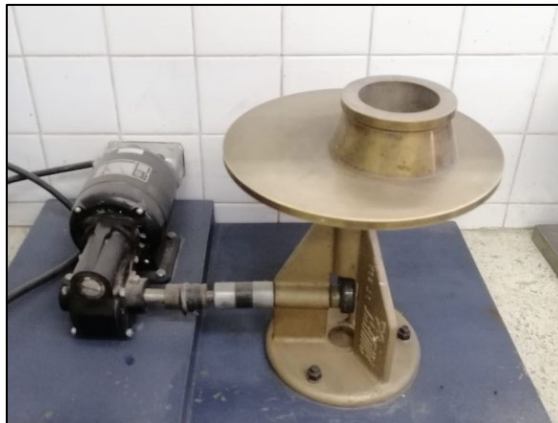
Figura 2.8 Mesa de flujo y molde cónico.
