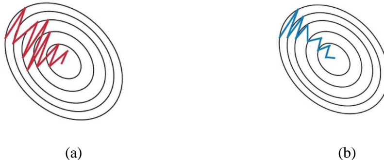
Figura 1.5. Descenso del gradiente estocastico sin momentum (a) y con momentum (b).
