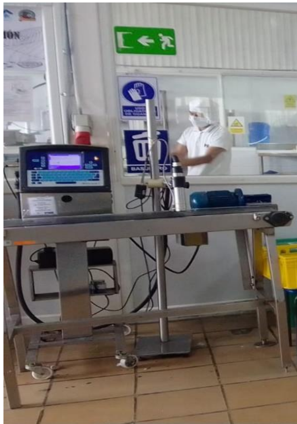
Figura 31. Codificador de Datos para trazabilidad Fuente: Elaboración Propia
