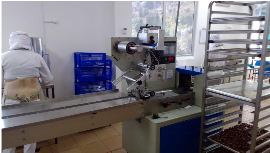
Figura 28. Empacadora de Tabletas (2018) Fuente: Elaboración Propia
