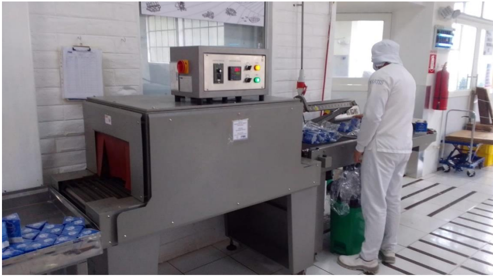
Figura 30. Túnel termo encogible Fuente: Elaboración Propia
