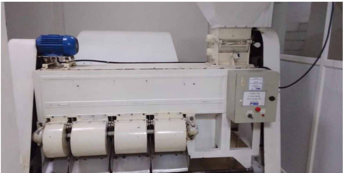
Figura 20. Proceso de pilado donde se separa los nibs de cacao de la cascara (2015) Fuente: Elaboración Propia
