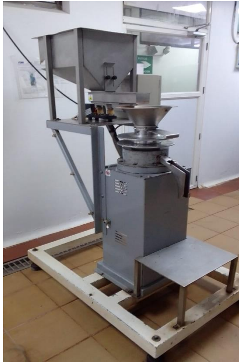
Figura 21. Premolino, se coloca los nibs de cacao para obtener pasta de cacao Fuente: Elaboración Propia
