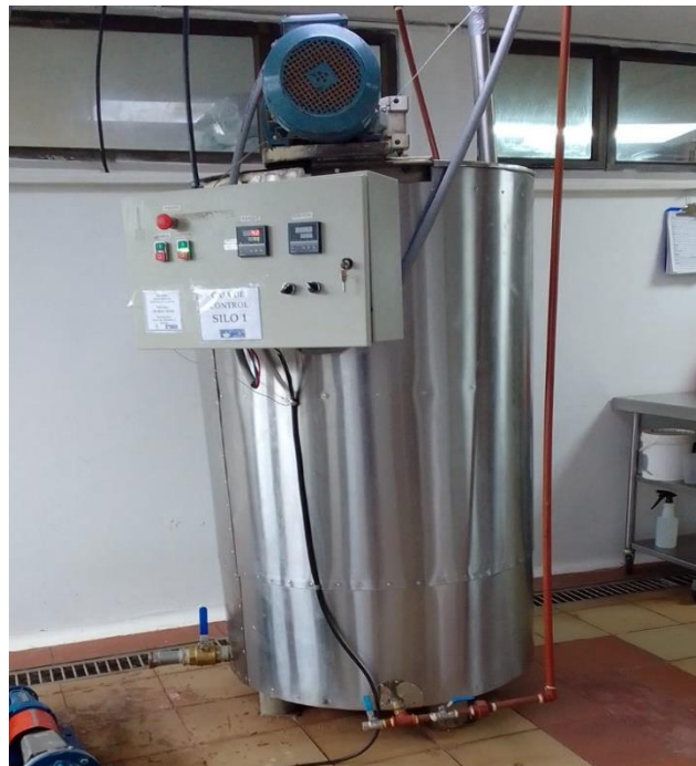
Figura 24. Silo para almacenamiento de chocolate refinado Fuente: Elaboración Propia
