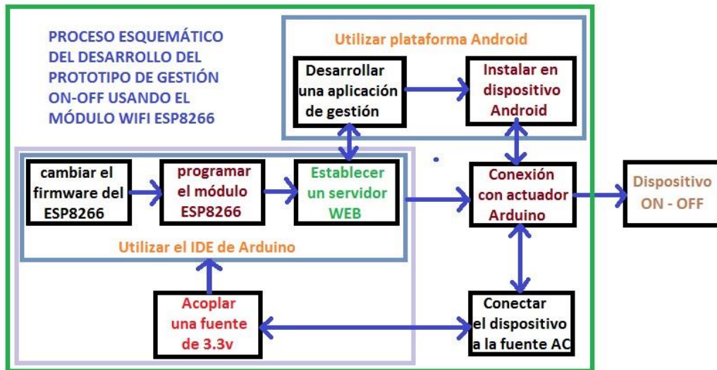
Figura 2.19. Diagrama de bloques para el diseño
