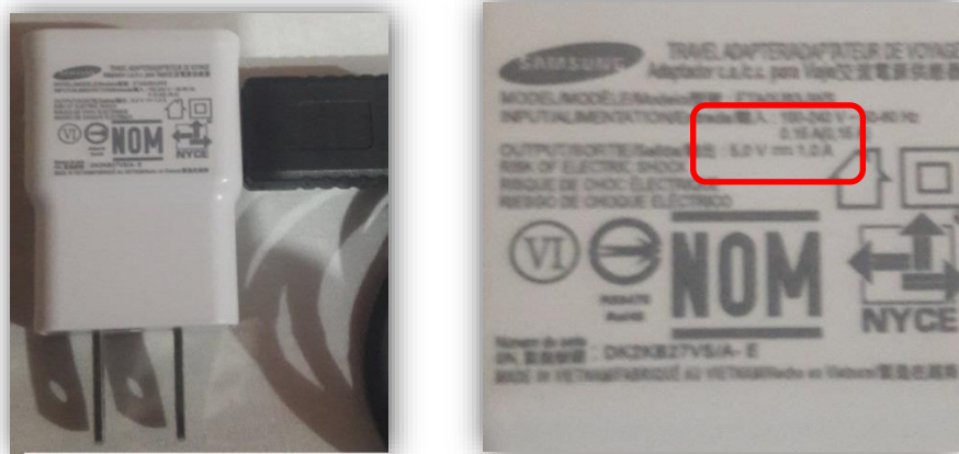
Figura 3.1. Fuente regulada de 5VDC - 1A
