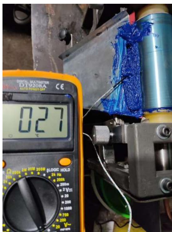
Figura 3.10. Lectura de la termocupla en la pintura después del proceso de molienda.
