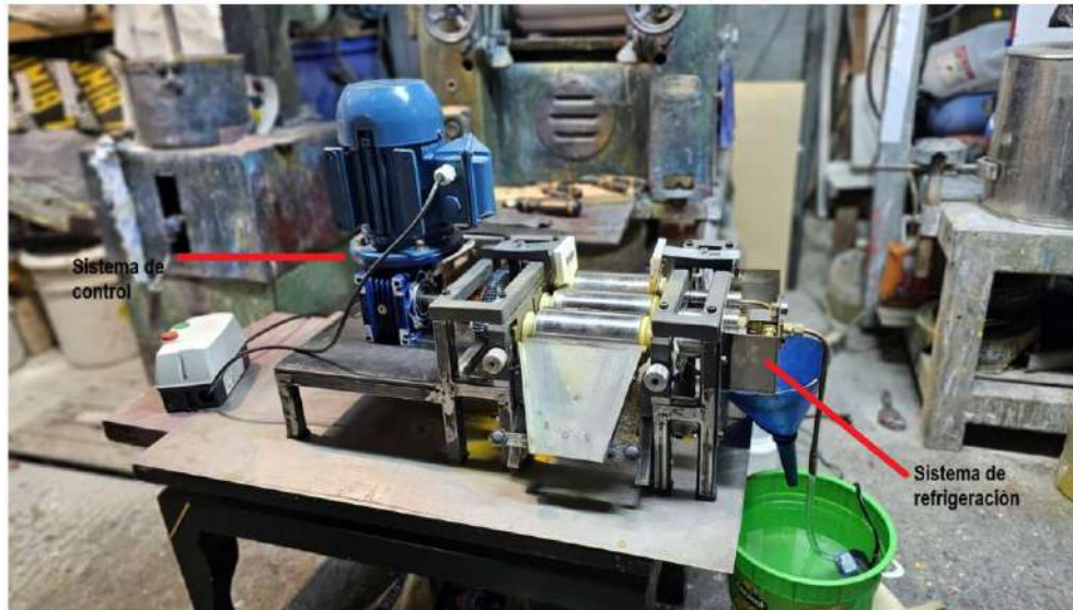
Figura 3.4. Prototipo de molino de tres rodillos.
