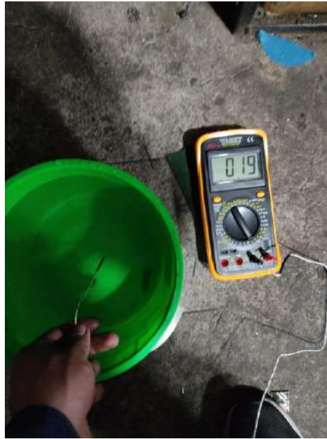
Figura 3.7. Lectura de la termocupla en el agua del tanque y que ingresa a los rodillos.
