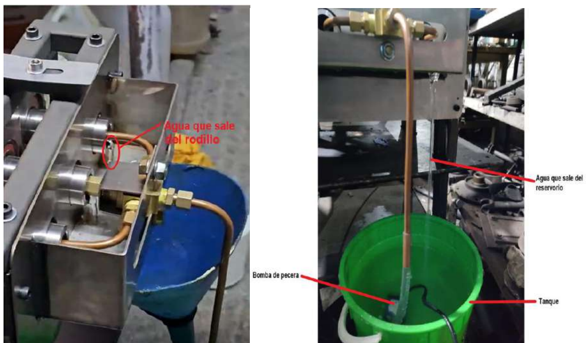
Figura 3.5. Sistema de refrigeración en vacío.
