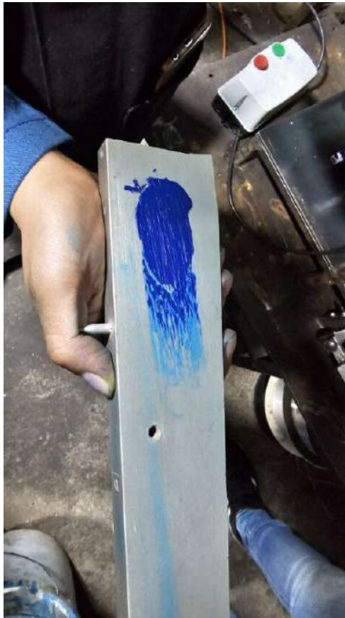
Figura 3.11. Marca que deja la pintura en la placa antes del proceso de molienda.
