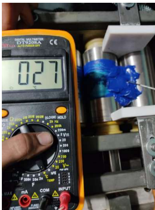
Figura 3.9. Lectura de la termocupla en la pintura antes del proceso de molienda.
