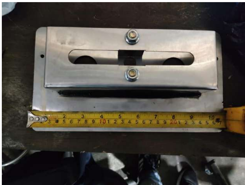
Figura 3.14. Dimensiones totales del reservorio de agua.
