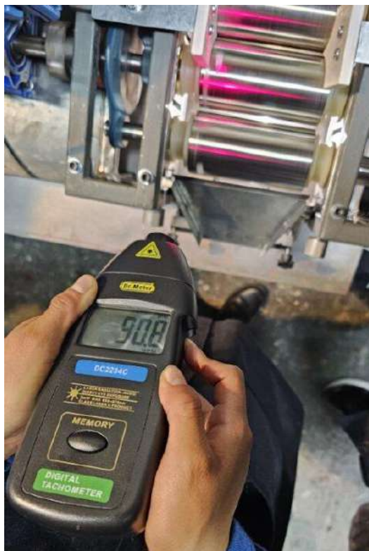
Figura 3.6. Lectura de tocómetro del rodillo central que está conectado al eje motriz.
