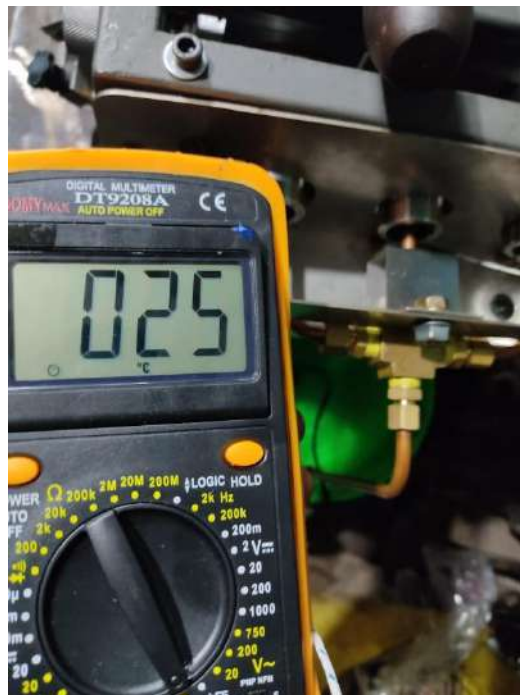
Figura 3.8. Lectura de la termocupla en el agua en la salida de los rodillos después de la operación de molienda.
