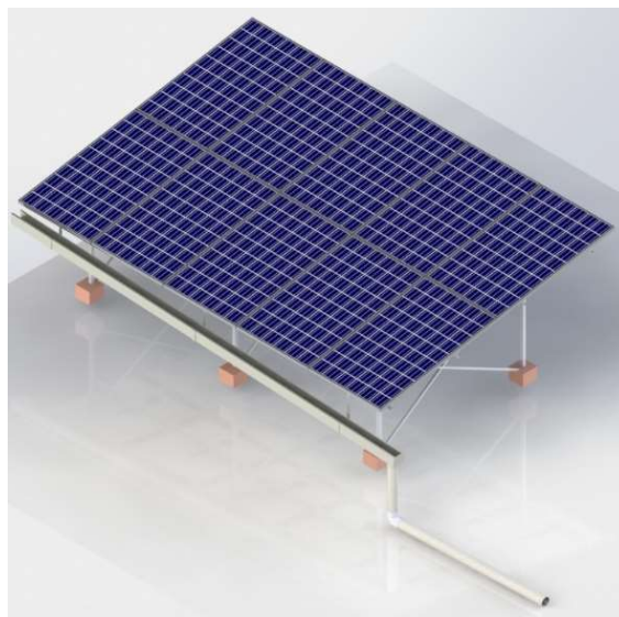
Figura 5. Módulo de captación
