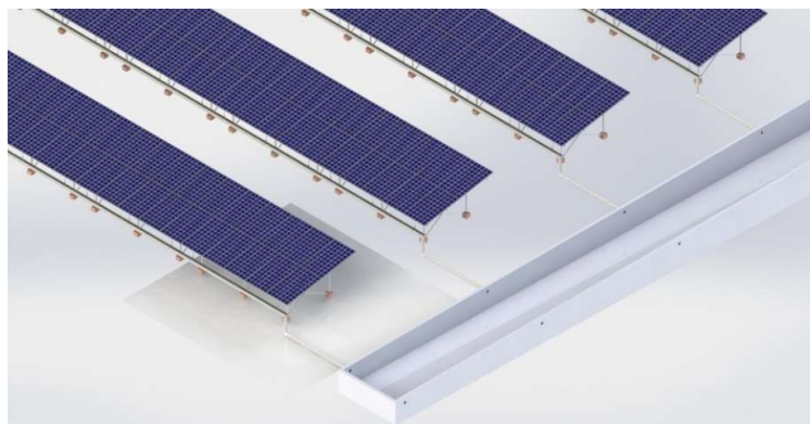
Figura 9. Conexión de varias filas de módulos con la acequia
