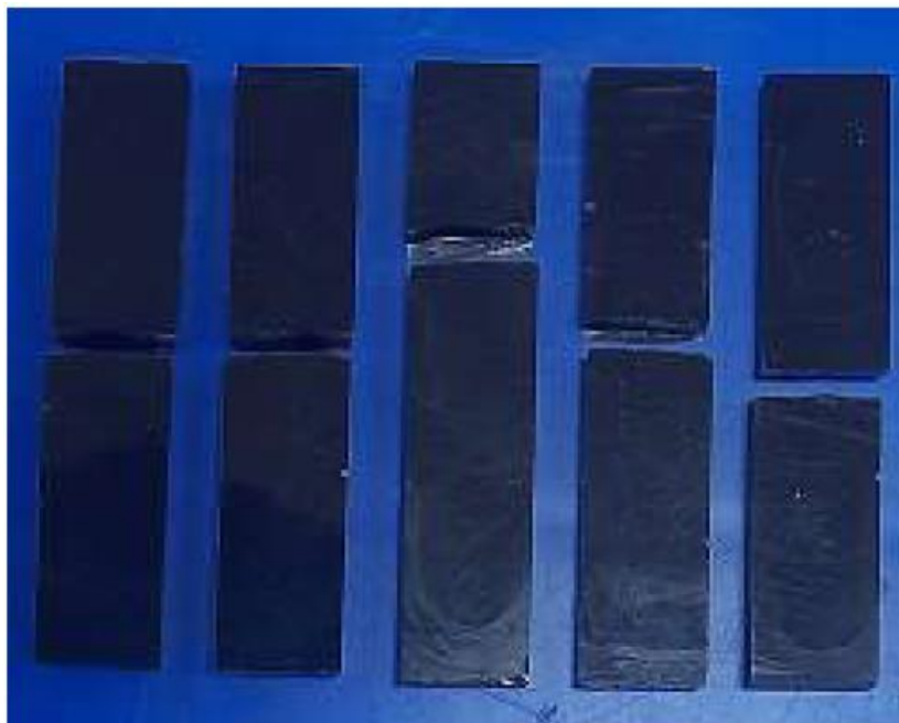
Figura D. 2 Probetas fracturadas de EP-M-0.75%AC-T2-NS [Fuente: propia].
