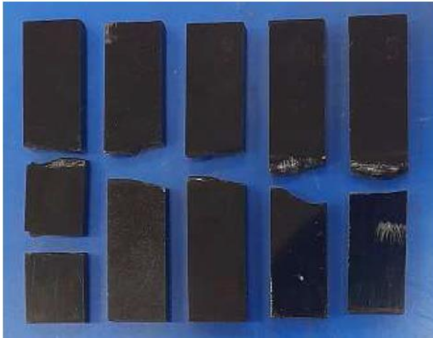
Figura D. 3 Probetas fracturadas de EP-M-1.5%AC-T2-S [Fuente: propia].
