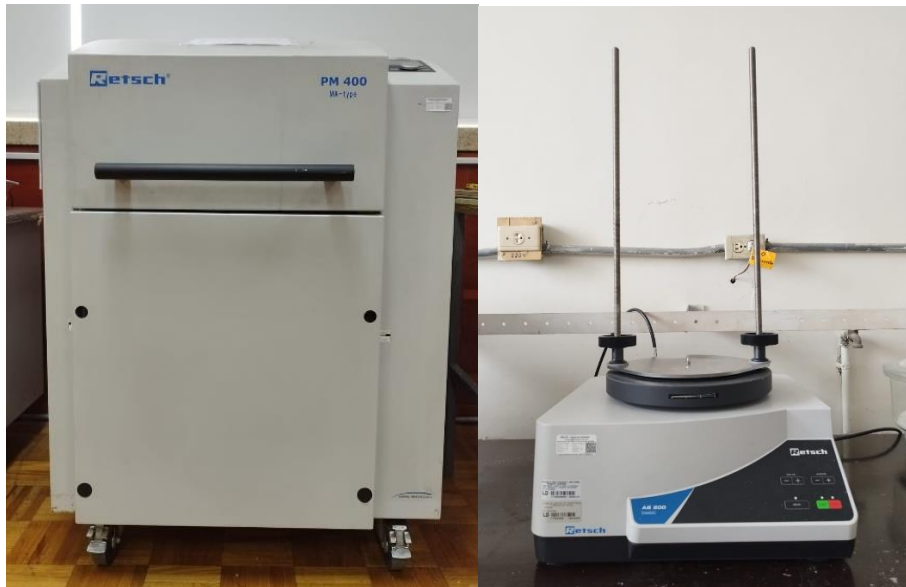
Figura 2. 2 a) Molino planetario de bolas RETSCH-PM400, y b) equipo de tamizado RETSCH-AS200 [Fuente: propia].
