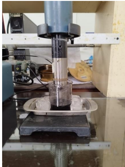
Figura 2. 11 Dispersión ultrasónica del material compuesto [Fuente propia].
