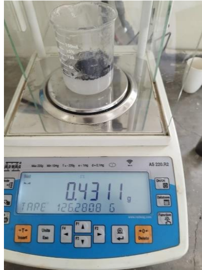
Figura 2. 10 Adición de refuerzo particulado de carbón activado a la matriz epóxica [Fuente: propia].
