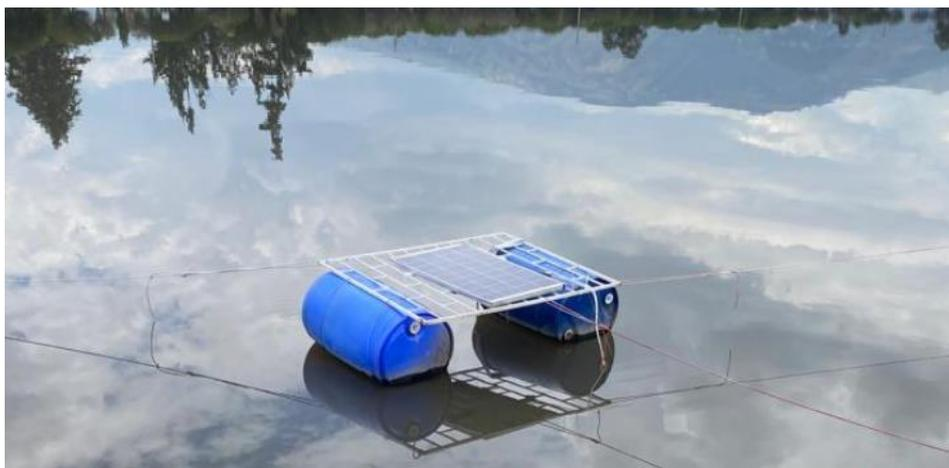
**Figura 2.7** Panel solar Flotante. Fuente propia.
