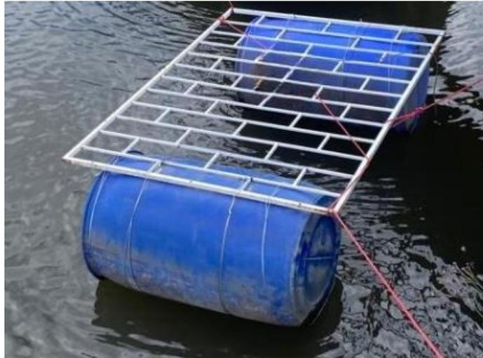
**Figura 2.4** Estructura de flotador. Fuente propia.
