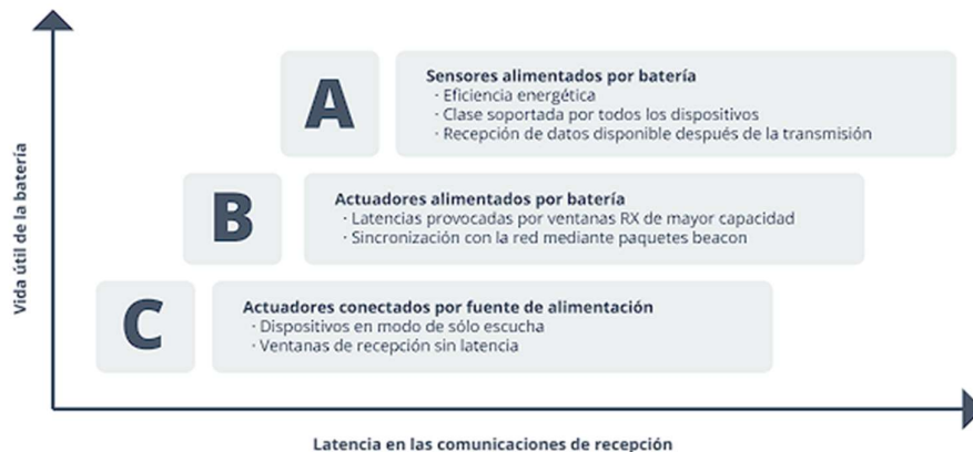
Figura 2.8. Clases de los nodos finales LoRaWAN. [13]
