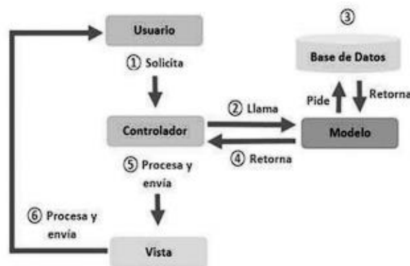
Figura 2.10. Funcionamiento de patrón MVC [19]
