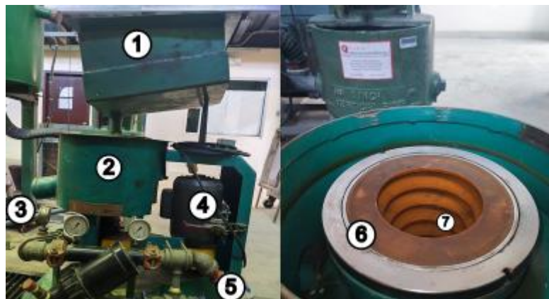
Figura 2.3.1. Concentrador Knelson MD7,5 empleado en los ensayos (1: Tolva de alimentación, 2: Cámara de fluidización, 3: Descarga del relave, 4: Motor, 5: Línea de fluidización, 6: Cono concentrador, 7: Anillos concentradores).
