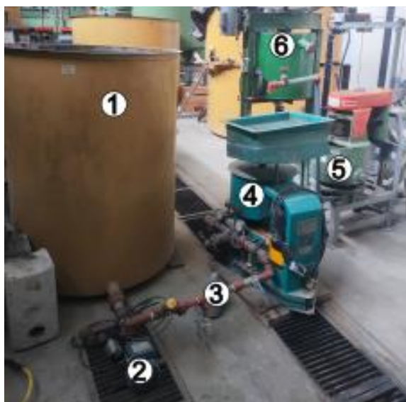
Figura 2.1.1. Sistema de procesamiento a emplear (1: Tanque de almacenamiento del agua de fluidización, 2: Bomba centrífuga, 3: Línea de alimentación del agua de fluidización, 4: Concentrador Knelson, 5: Bomba de lodos, 6: Tanque de acondicionamiento).
