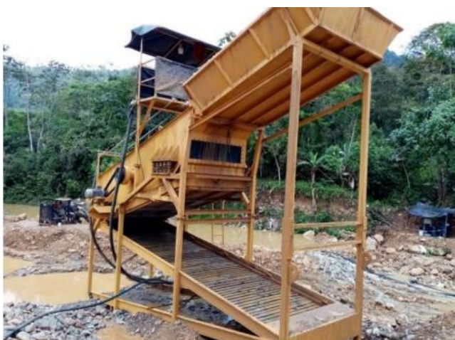
Figura 1.4.3. Concentrador de tipo “z” (Japa Suquilanda and Sanango Zaruma, 2022)
