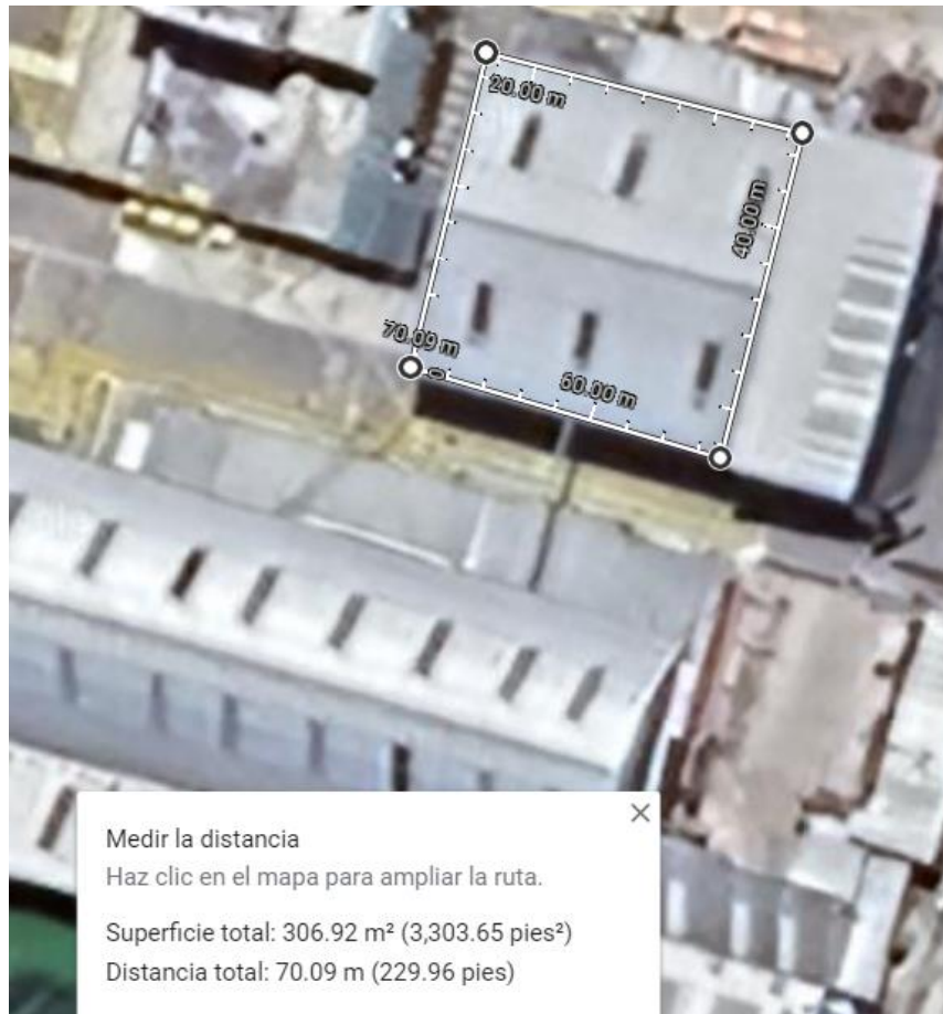
Figura 2.4. Espacio para la instalación del sistema fotovoltaico. Fuente: [29]
