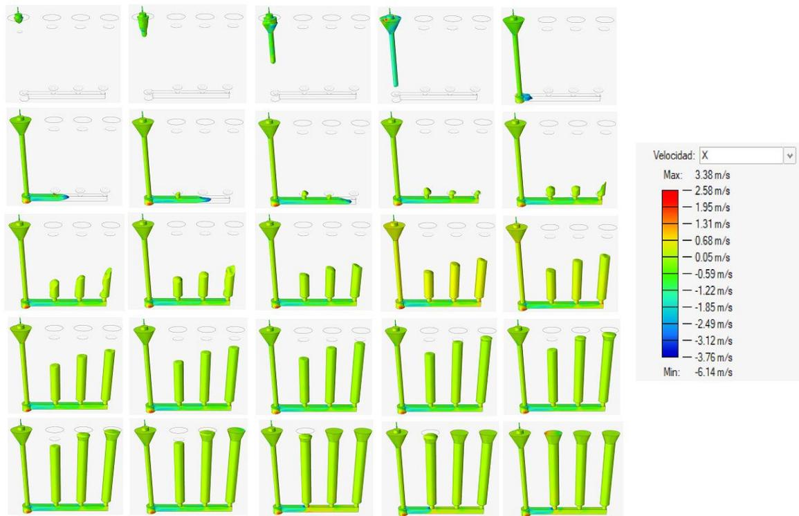
Figura Velocidad metal líquido en el eje x de las probetas en posición vertical.
