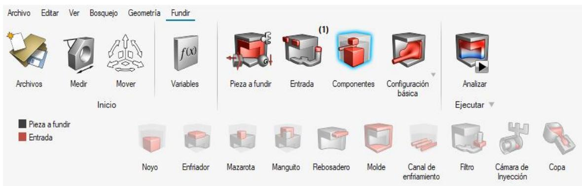
Figura 2.7 Componentes del sistema de alimentación y molde.
