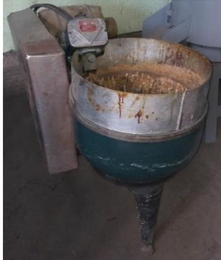
Figura 2.19 Mezcladora. Escuela Politécnica Nacional – Facultad de Ingeniería Mecánica (Laboratorio de Fundición).
