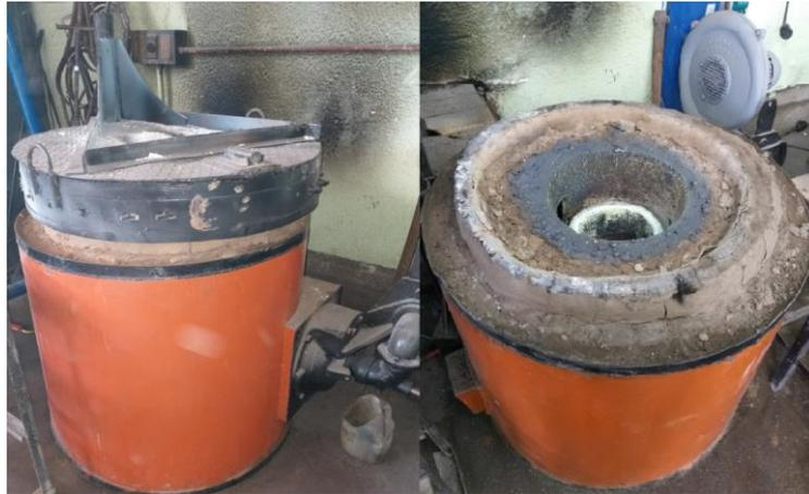
Figura 2.26 Horno a diésel fijo de crisol móvil.
