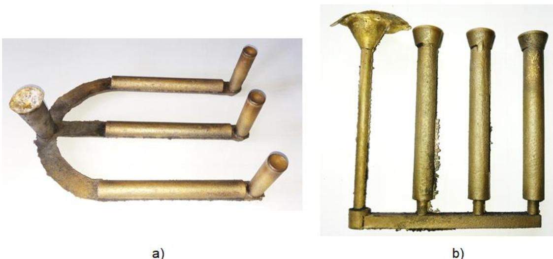
Figura 3.1 Fundición. a) Colado de probetas en posición horizontal, b) Colado de probetas en posición vertical.
