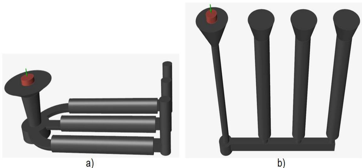
Figura 2.6 Entrada metal líquido. a) Probetas en posición horizontal y b) Probetas en posición vertical.
