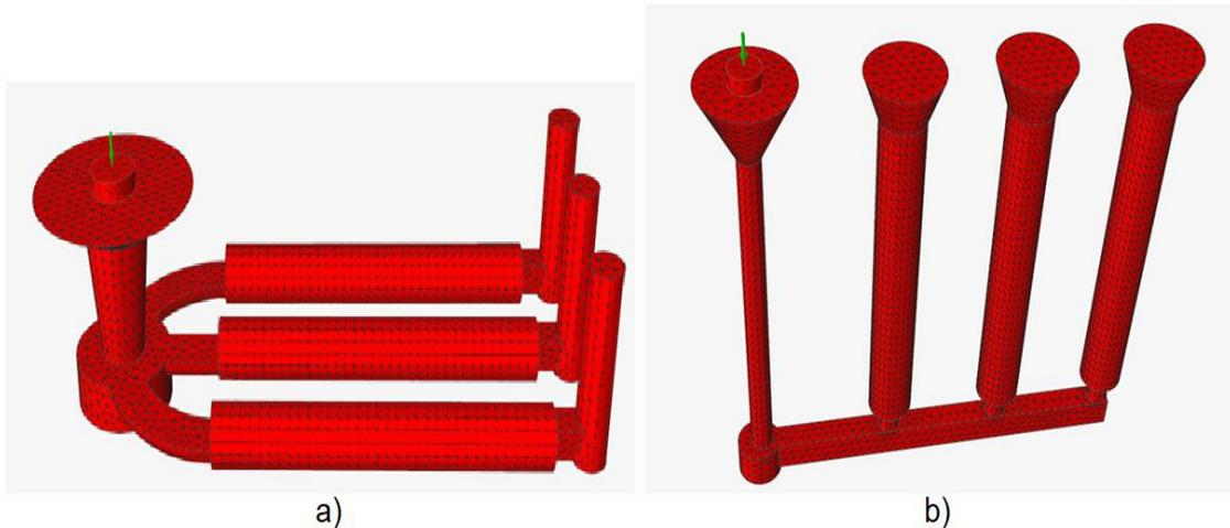
Figura 2.11 Malla. a) Probetas en posición horizontal y b) Probetas en posición vertical.
