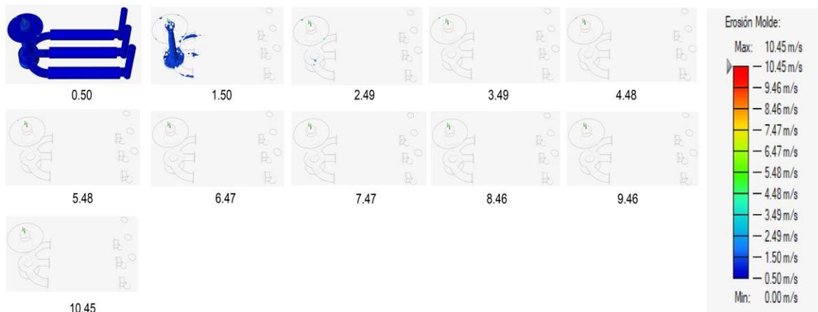
Figura 3.15 Erosión molde probetas en posición horizontal.
