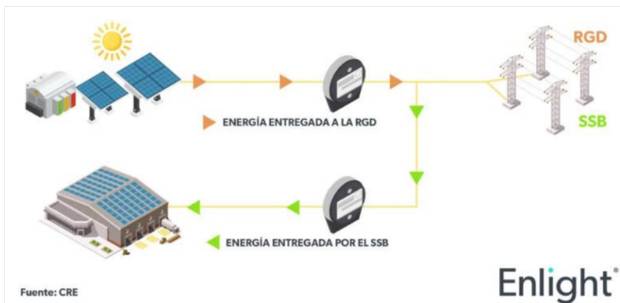
Figura 8. Esquema de Facturación Neta [10]
