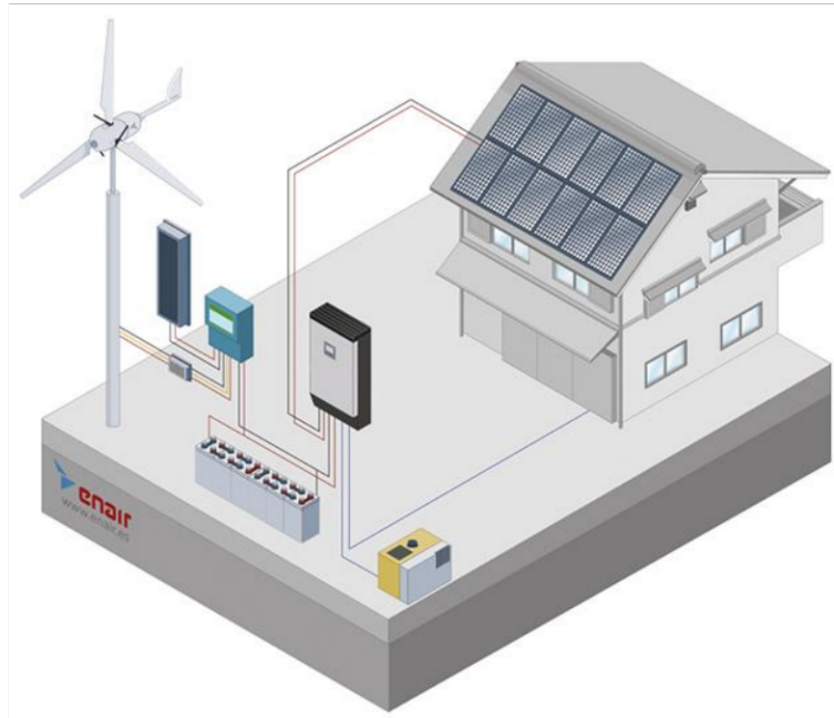
Figura 3. Esquema de Generación Distribuida eólica [5]
