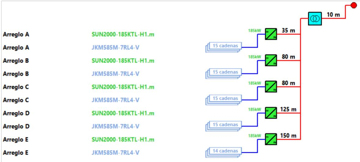
Figura 3.1. Diagrama unifilar del sistema obtenido de PVsyst [4].
