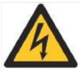
Figura 1.6. Peligro Voltaje Peligroso, este letrero indica que existe un peligro que puede terminar en una herida o muerte por electrocución. [12]
