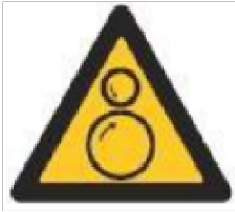
Figura 1.8 Advertencia Partes Rotatorias, este letrero indica que existe un peligro que puede resultar en heridas o pérdida de extremidades por partes que rotan. [12]
