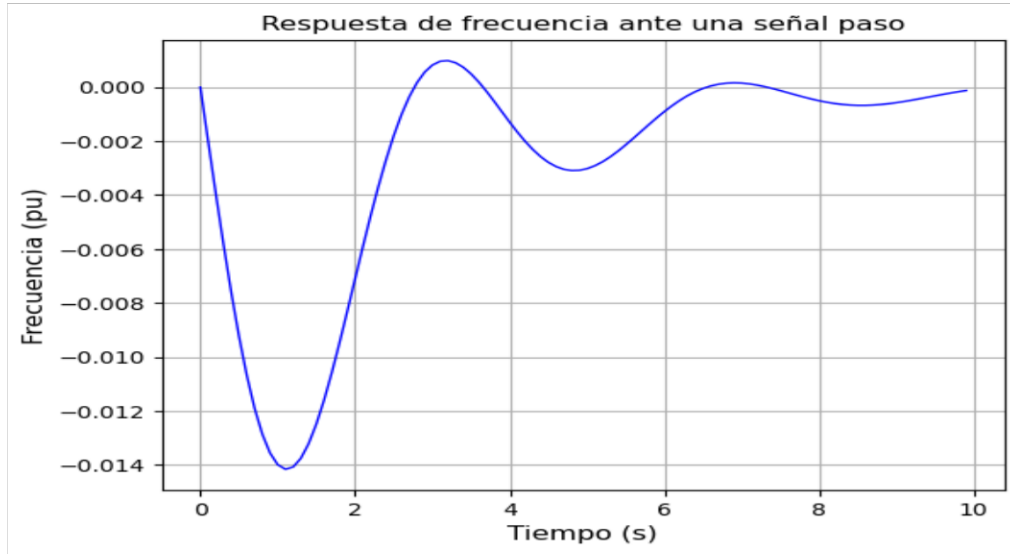
Figura 2.10. Respuesta ante una señal paso de la variación de frecuencia obtenida en PYTHON
