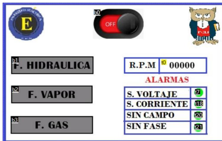
**Figura 2.28.** Diseño de la pantalla NEXTION
