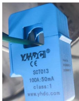
Figura 2.32. Medidor de corriente
