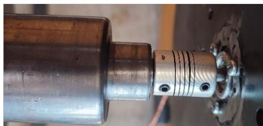
**Figura 2.12.** Acople para el eje del motor con el encoder
