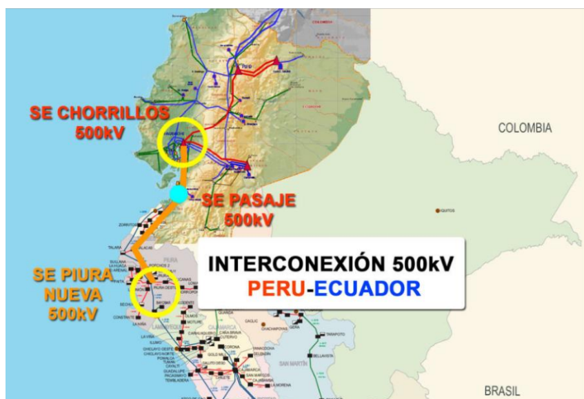
Figura 8. Diagrama de la línea de transmisión de la interconexión Perú - Ecuador de 500 kV. [16]
