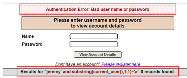
Figura 2.11 Resultado de consulta SQL-Injection verificar primera letra de usuario
