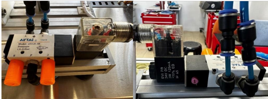
Figura 5.12. Electroválvula 5/2 AIRTAC 4V210-08.
