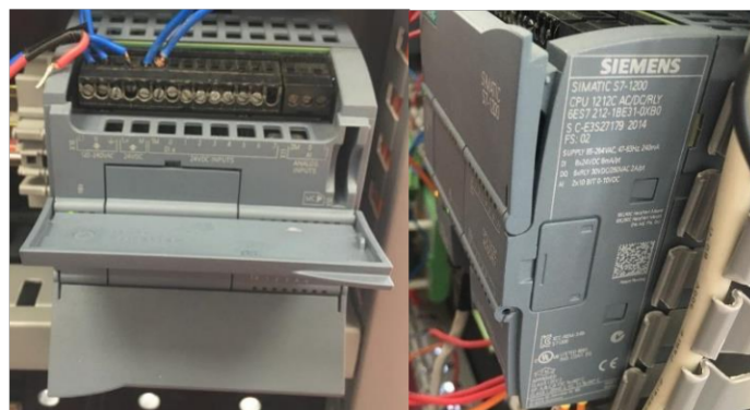
Figura 5.23. PLC S7-1200 CPU: 1212C AC/DC/RLY N° Orden: 6ES7212-1BE31-0XB0.
