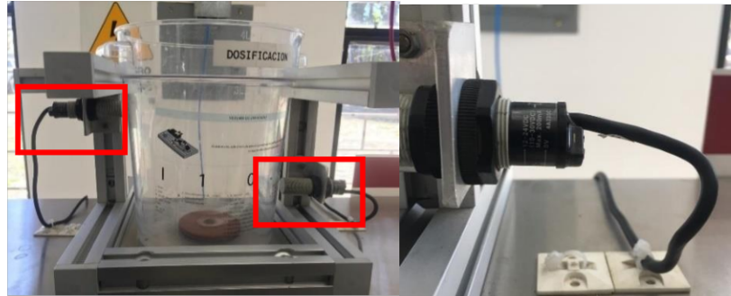
Figura 5.9. Sensor de proximidad capacitivos CR18-8DP.
