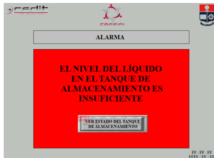
Figura 5.67. Ventana de alarma emergente para el nivel insuficiente del tanque de almacenamiento.
