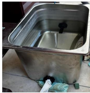
Figura 5.29. Tanque de reserva del líquido.
