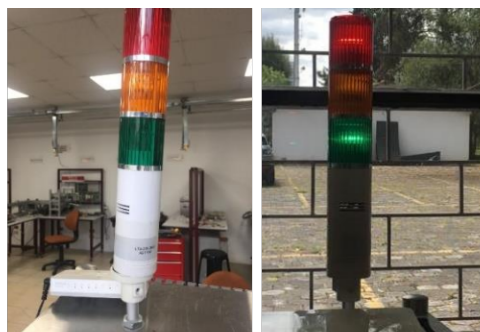
Figura 5.3. Torre de advertencia multinivel LTA-205-3WJ.
