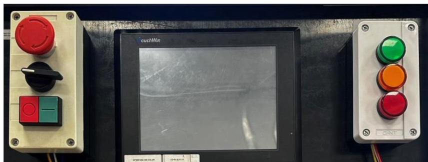
Figura 5.38. Posicionamiento de la botonera, pantalla y luces piloto en el panel de control.
