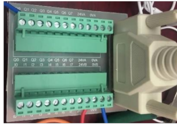
Figura 5.28. Módulo complementario interfaz DB25.
