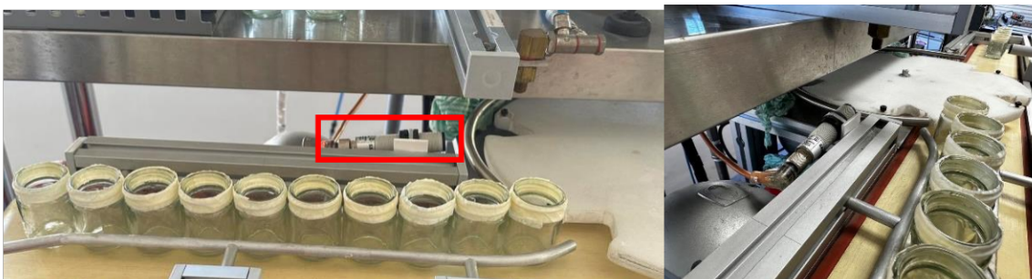
Figura 5.35. Nuevo posicionamiento para el primer sensor fotoeléctrico.
