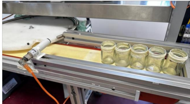
Figura 5.36. Nuevo posicionamiento para el segundo sensor fotoeléctrico.
