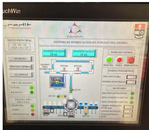
Figura 5.98. Dosificación en función del tiempo (14 y 28 mL).
