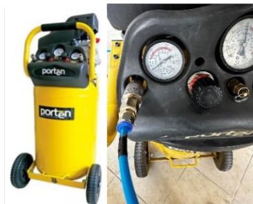
Figura 5.33. Compresor de aire Porten 2 HP 75 litros.
