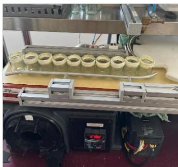
Figura 5.89. Posicionamiento de los envases vacíos en la banda transportadora.
