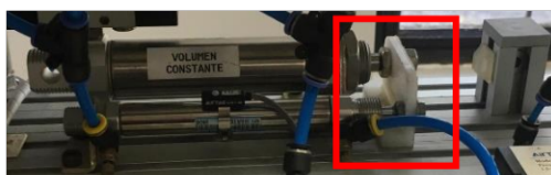
Figura 2.11. Acople rígido entre los vástagos de los cilindros neumático e hidráulico.
