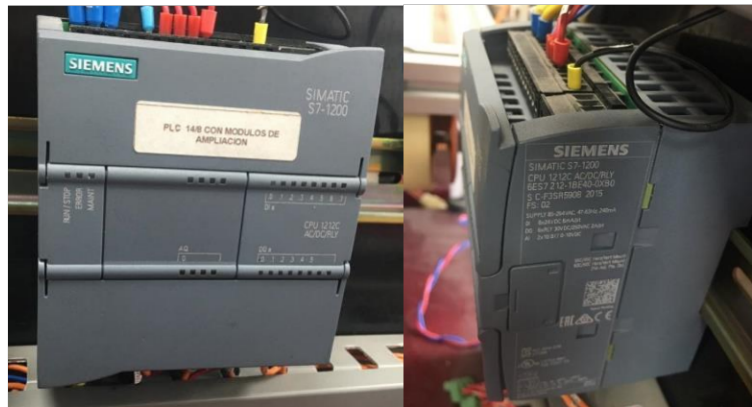
Figura 5.1. PLC S7-1200 CPU: 1212C AC/DC/RLY N° Orden: 6ES7 212-1BE40-0XB0.
