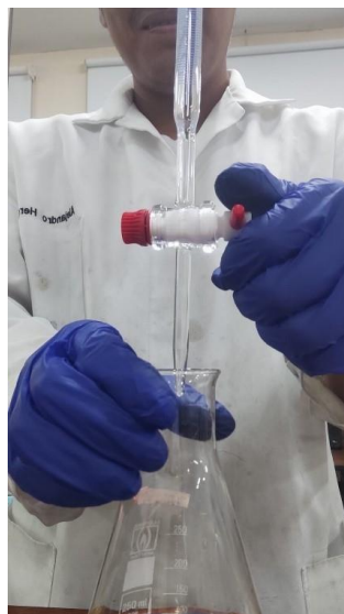
Figura 8. Proceso de Titulación Alcalinidad
