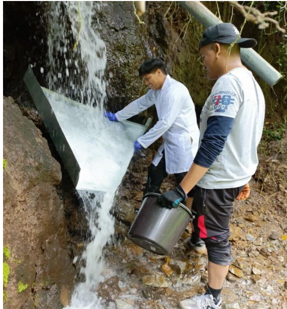
Figura 11. Medición del caudal
