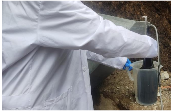
Figura 7. Medición con el Multiparámetros HPRIBA U-52
