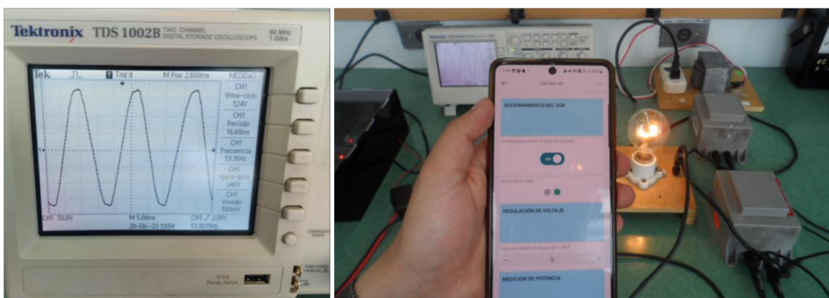
Figura 3.12. Relé controlado de estado sólido con carga R y dos cargas L en paralelo con un ángulo de disparo de 5^\circ
