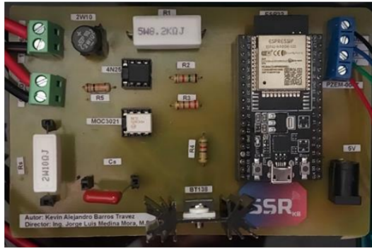
Figura III.3. PCB física del relé controlado de estado sólido
