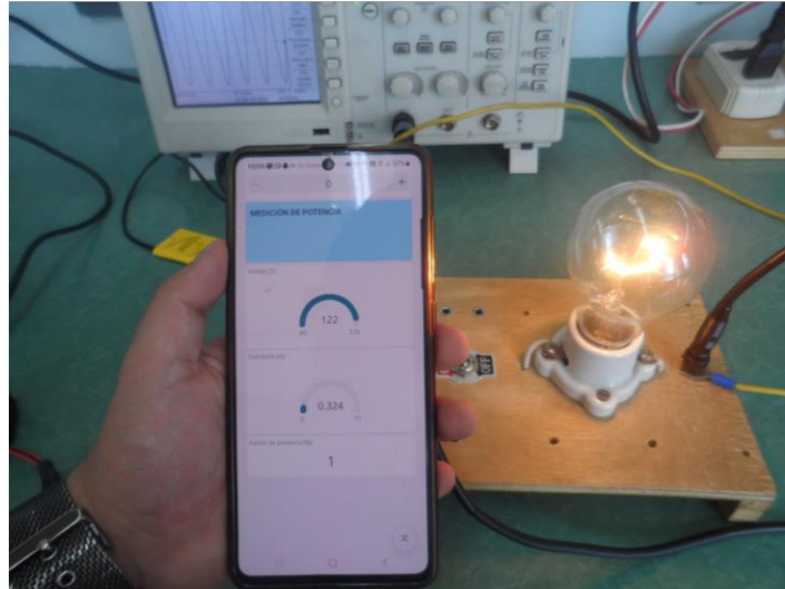
Figura 3.4. Medición de potencia a los 0 grados eléctricos
