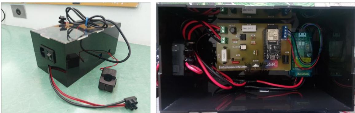
Figura 3.1. Prototipo del relé controlado de estado sólido
