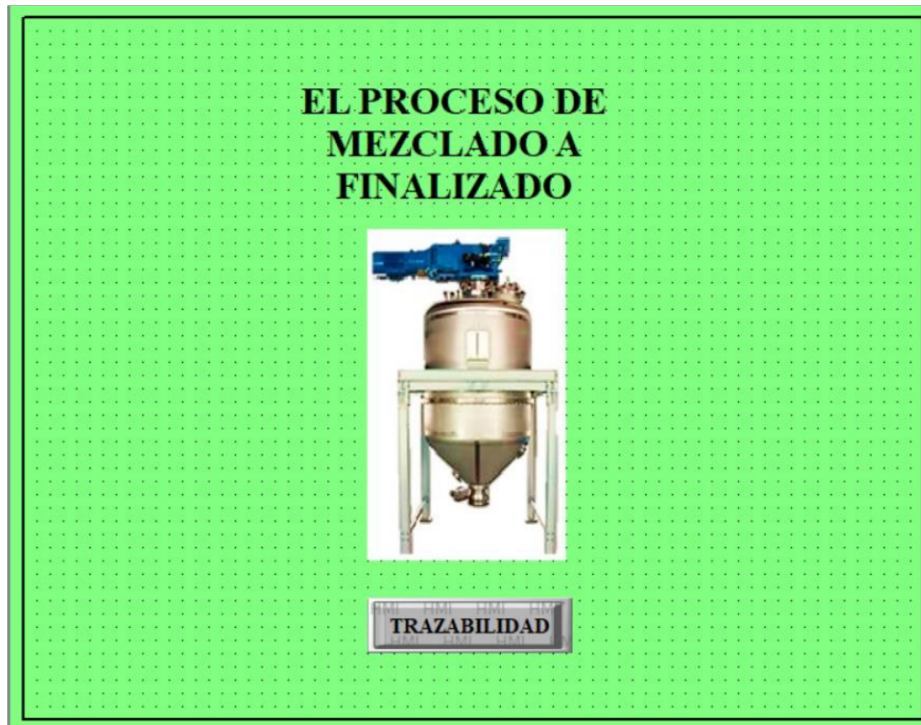
Figura 5.8. Ventana que permite acceder a los datos de la trazabilidad una vez que el proceso ha terminado.
