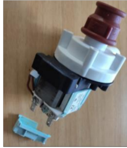
Figura 2.11. Bomba de agua fuera de funcionamiento.
