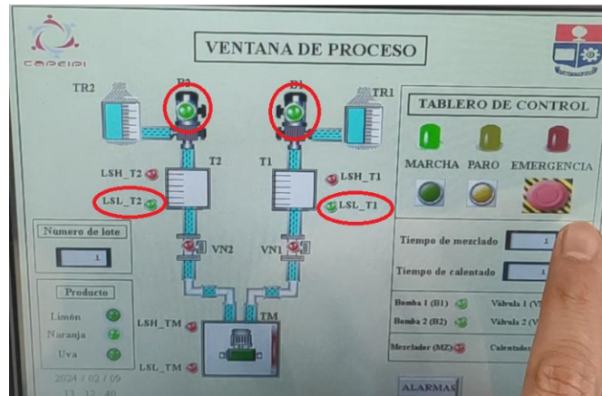
Figura 3.8. Luces que indican el funcionamiento de los equipos.
