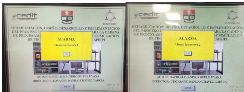
Figura 3.3. Alarma generada en el proceso por el nivel bajo de las reservas.
