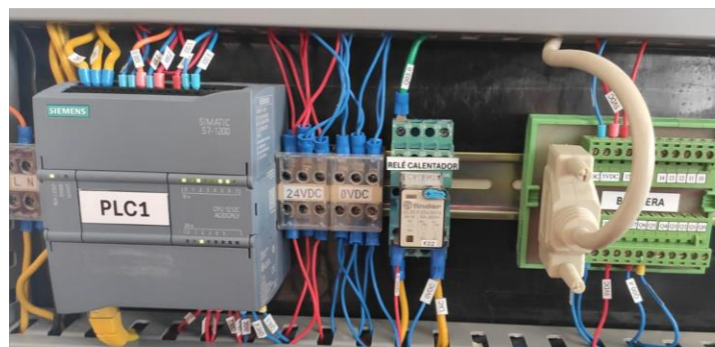
Figura 3.31. Etiquetado de los elementos del módulo.
