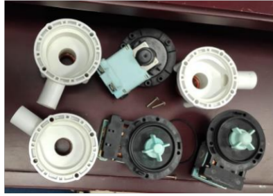
Figura 2.8. Bombas de agua después de la limpieza.
