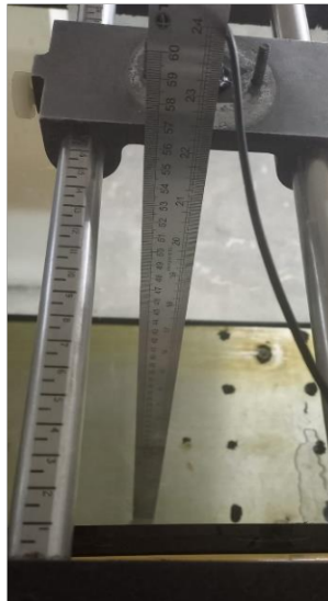
Figura 5.3. Medición de distancia de instalación del sensor.
