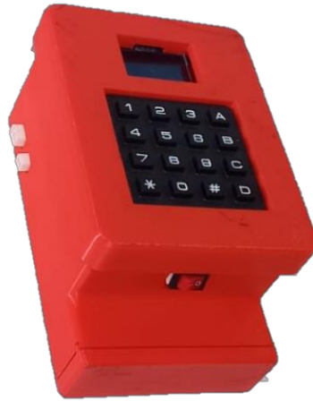
Figura 3.2. Carcasa del sistema de captación de datos
