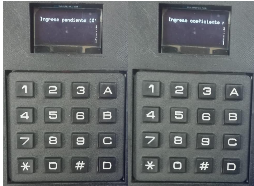
Figura 5.8. Ingreso de pendiente y coeficiente de rugosidad.
