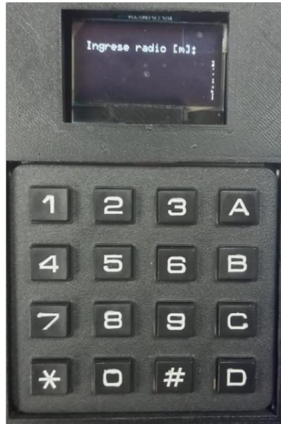
Figura 5.6. Ingreso de dimensiones de cañería
