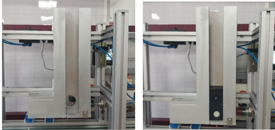
Figura 2.8. Montaje del contenedor de empaques de papas diseñado.
