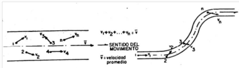
Figura 2. Representación gráfica del flujo turbulento.[2]
