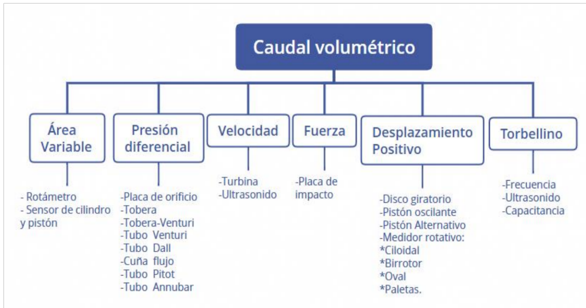
Figura 3. Clasificación de los medidores de flujo volumétrico.[3]
