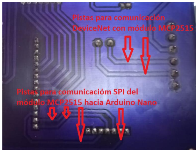
Figura 4.5. Distancias de pistas para comunicacion DeviceNet y SPI
