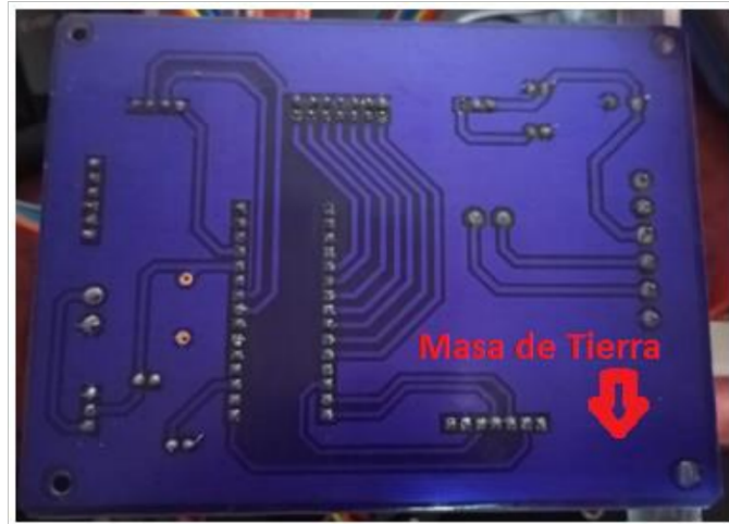
Figura 4.6. Masa de tierra en la PCB diseñada
