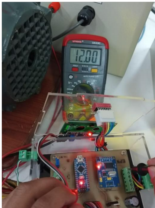
Figura 3.1. Prueba de nivel de voltaje de alimentación para tarjeta de desarrollo Arduino Nano
